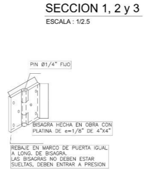
DETALLE DE BISAGRA ESCALA : 1/2.5
