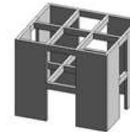
Muros de Carga
