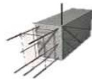
VIGA DE CONCRETO ARMADO
