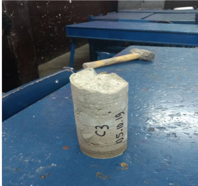
Fotografía N° 18: testigo diamantino C-3 en la columna del 2° piso del pabellón B de la I.E. Antonia Moreno de Cáceres
