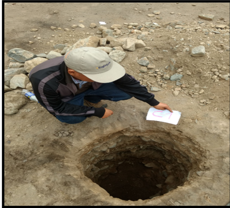
Fotografía N° 9: primera calicata en el colegio Antonia Moreno de Cáceres Se excavó a cielo abierto una profundidad de 3,00 m.
