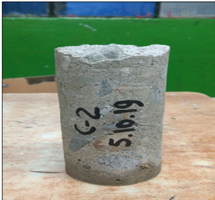
Fotografía N° 16: testigo diamantino C-2 en la columna del 1° piso del pabellón B de la I.E. Antonia Moreno de Cáceres
