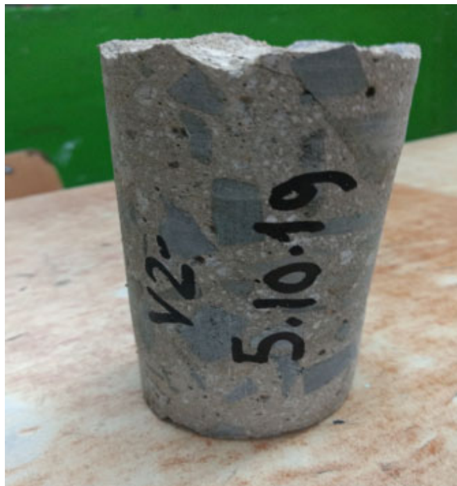
Fotografía N° 22: testigo diamantino V-2 en la viga del 1° piso del pabellón B de la I.E. Antonia Moreno de Cáceres
