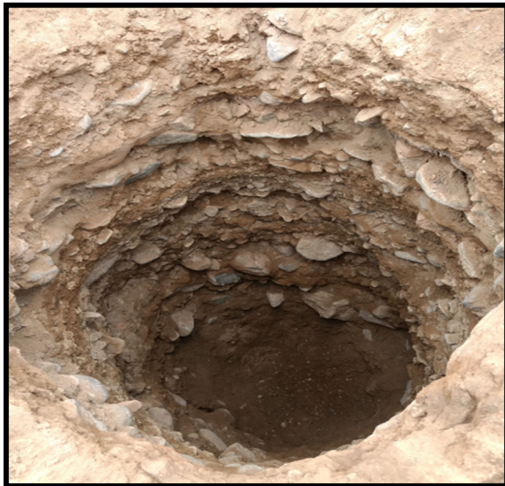
Fotografía N° 12: segunda calicata en el colegio Antonia Moreno de Cáceres Se excavó a cielo abierto una profundidad de 3,00 m.
