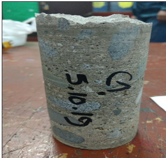
Fotografía N° 14: testigo diamantino C-1 en la columna del 1° piso del pabellón B de la I.E. Antonia Moreno de Cáceres
