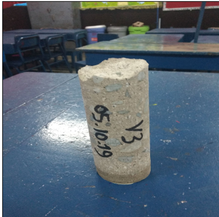
Fotografía N° 24: testigo diamantino V-3 en la viga del 2° piso del pabellón B de la I.E. Antonia Moreno de Cáceres
