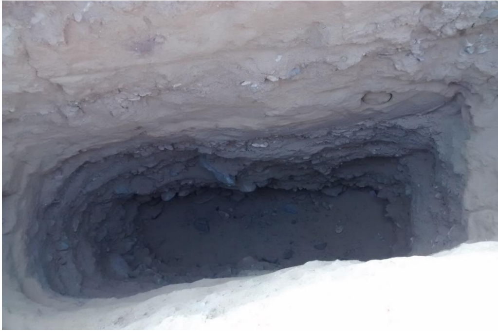
Figura N°26. Extracción de Muestras necesarias para poder realizar el Estudio de Mecánica de Suelos correspondiente.
