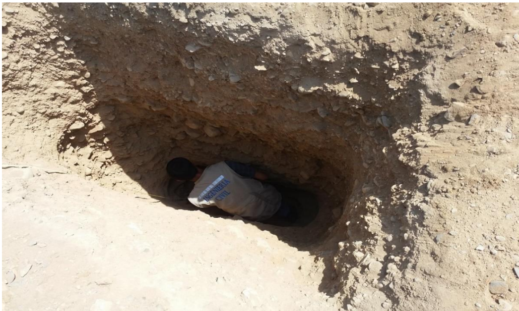
Figura N°25. Extracción de Muestras necesarias para poder realizar el Estudio de Mecánica de Suelos correspondiente.
