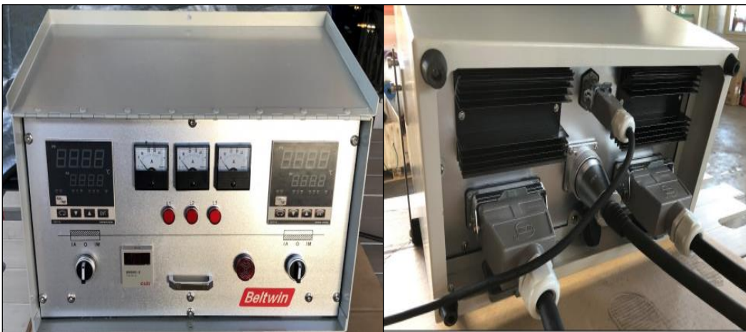
Figura 10: Caja de mando y Conectores de caja plato.
