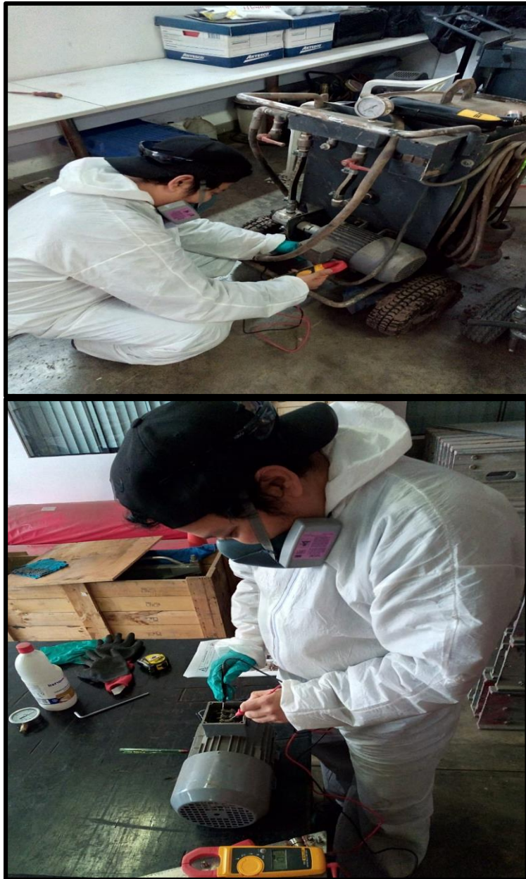
Figura 17: Realización de un mantenimiento preventivo programado a un motor de electrobomba.
