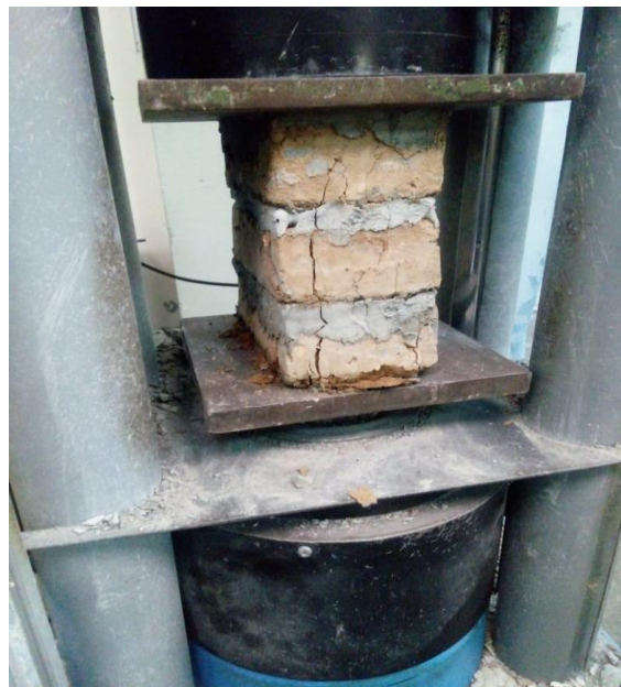
Figura 7.6: ensayo a compresión de pilas
