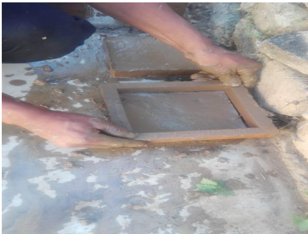
Figura 6. Proceso de elaboración del adobe
