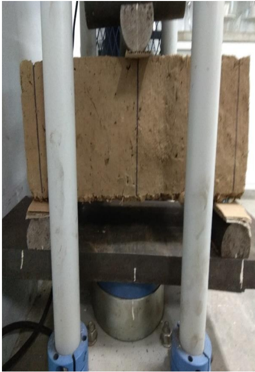
Figura 7.3: ensayo a flexión
