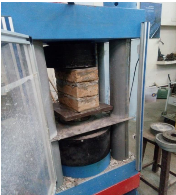
Figura 7.5: ensayo a compresión de pilas
