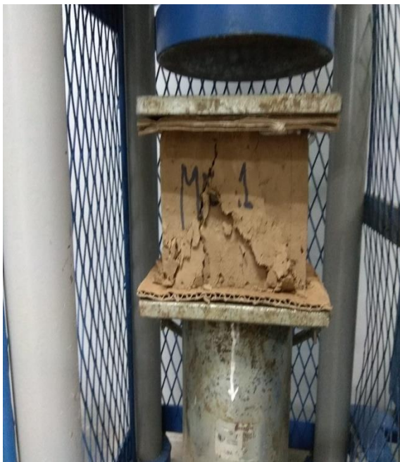
Figura 7.1: ensayo a compresión
