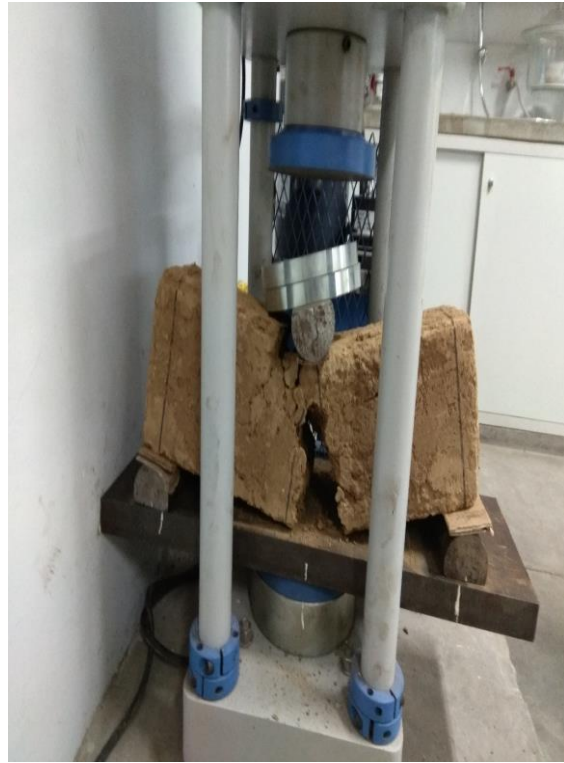
Figura 7.4: ensayo a flexión
