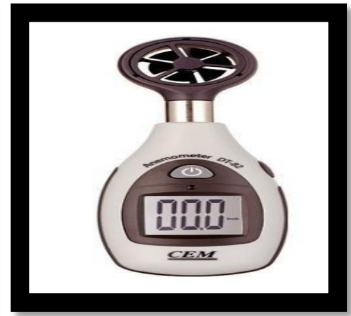
Figura N°04: anemómetro para medir la velocidad del viento Fuente: Elaboración propia
