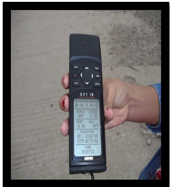
Figura N°53: GPS para ubicar las coordenadas del lugar
