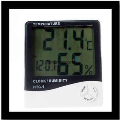
Figura N°50: higrómetro instrumento de medición de humedad y temperatura
