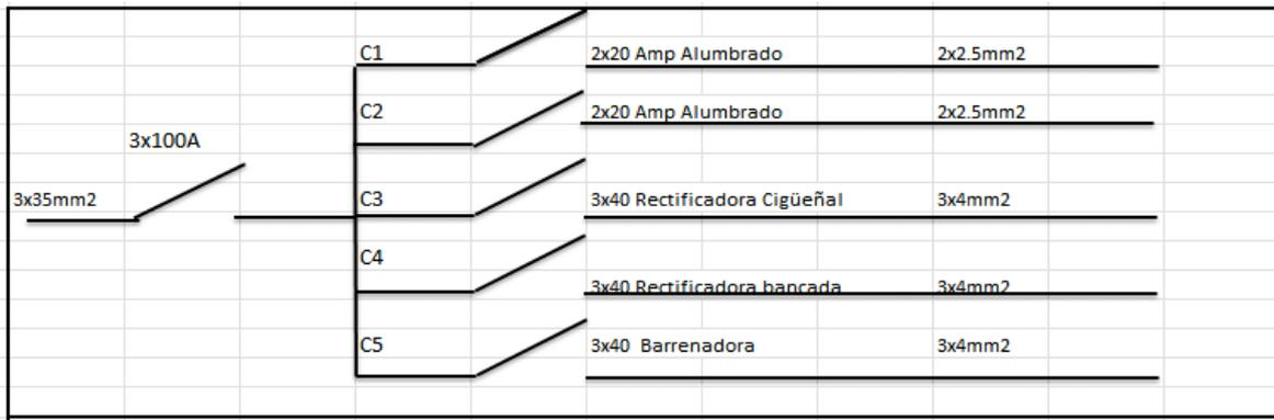
Figura 08. Diagrama Unifilar Taller 3 – Mecánica de Producción ISTE RFA.
