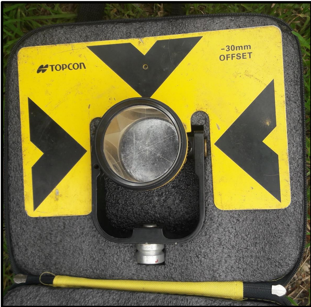
Fotografía N°10: prisma topográfico para medición de la marca Topcon
