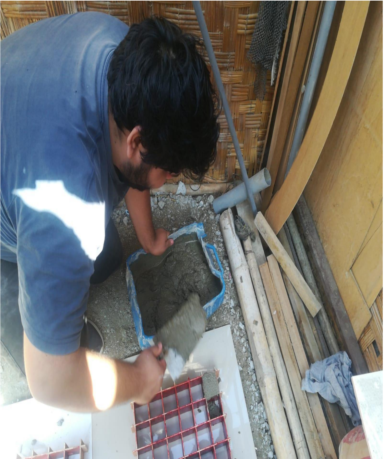
En la imagen se puede apreciar el momento de la preparación de los cubos del mortero de 2x2x2 pulgadas.
