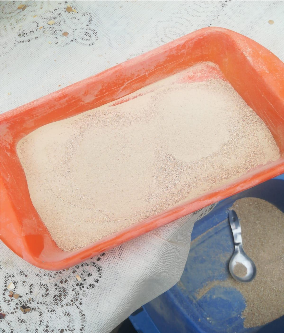
En la imagen se puede apreciar la cáscara de huevo ya vuelto ceniza
