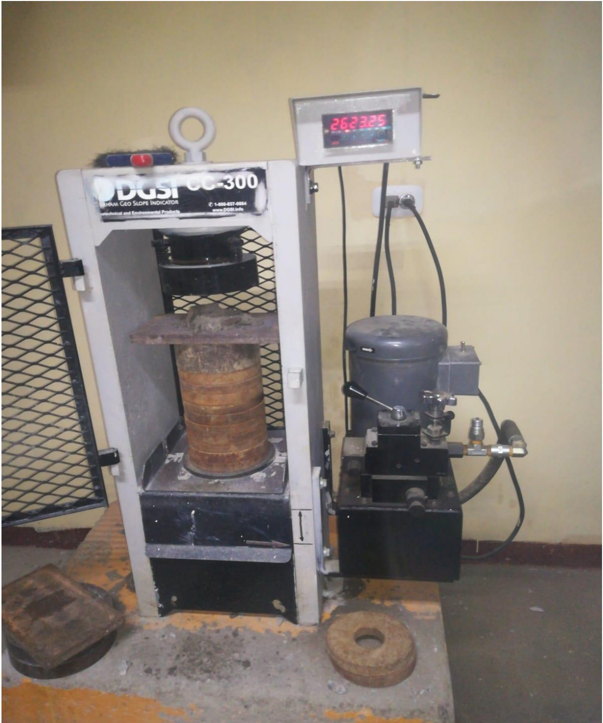
En la imagen se puede apreciar que la carga máxima de 2623.25kg en la máquina de rotulación
