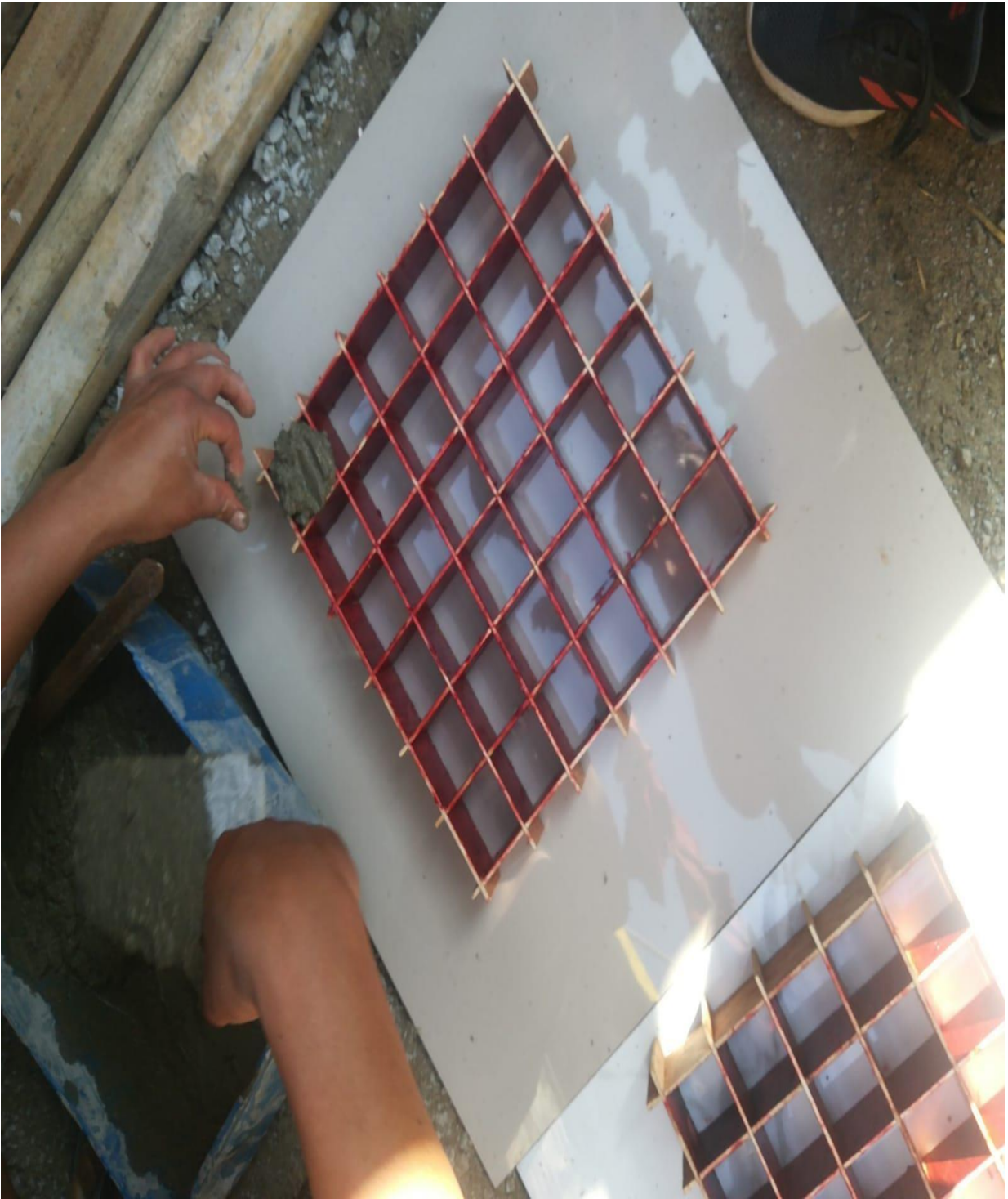
En la imagen se puede apreciar el momento de la preparación de los cubos del mortero de 2x2x2 pulgadas
