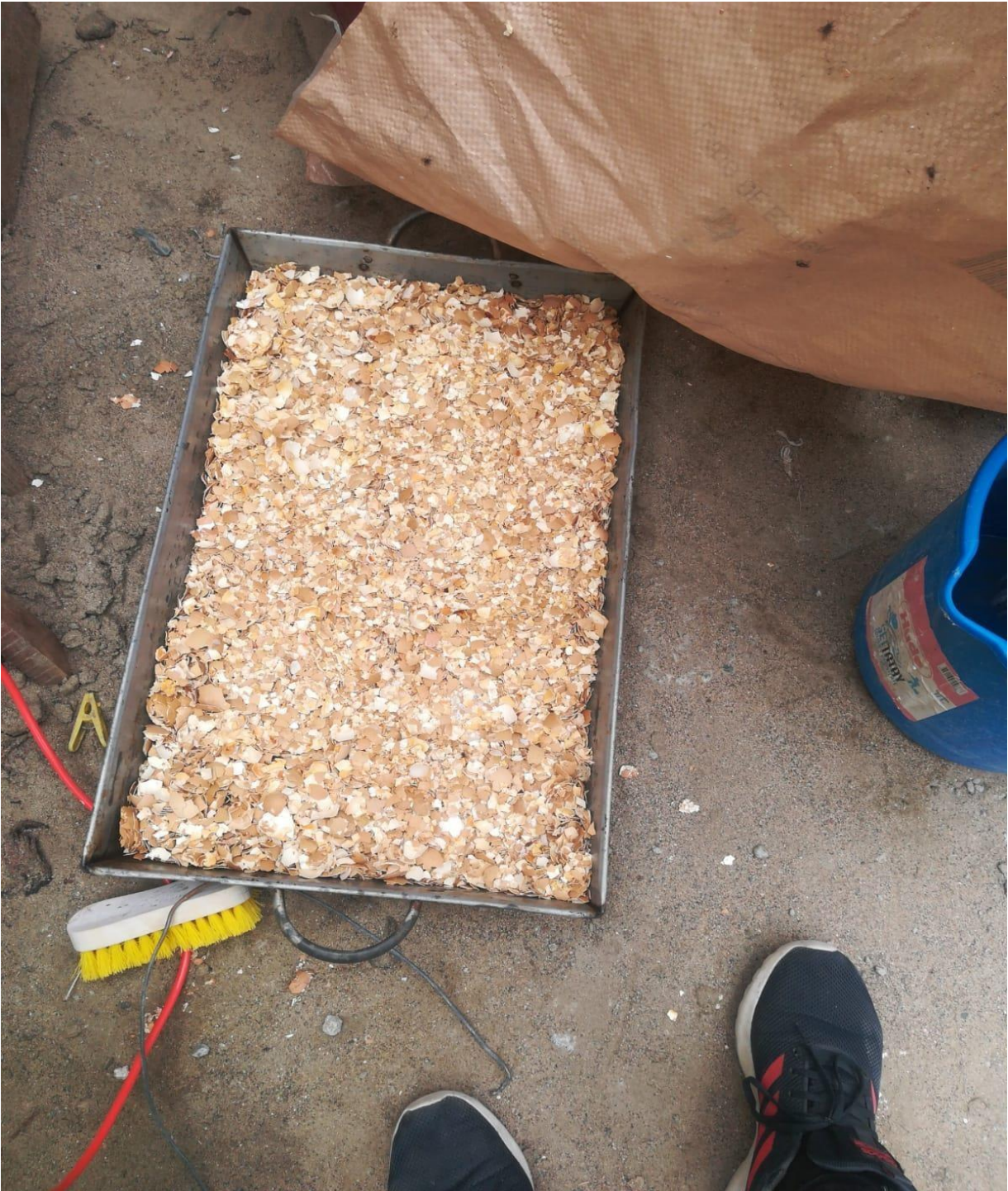
En la imagen se puede apreciar la cáscara de huevo ya triturada lista para llevar al horno
