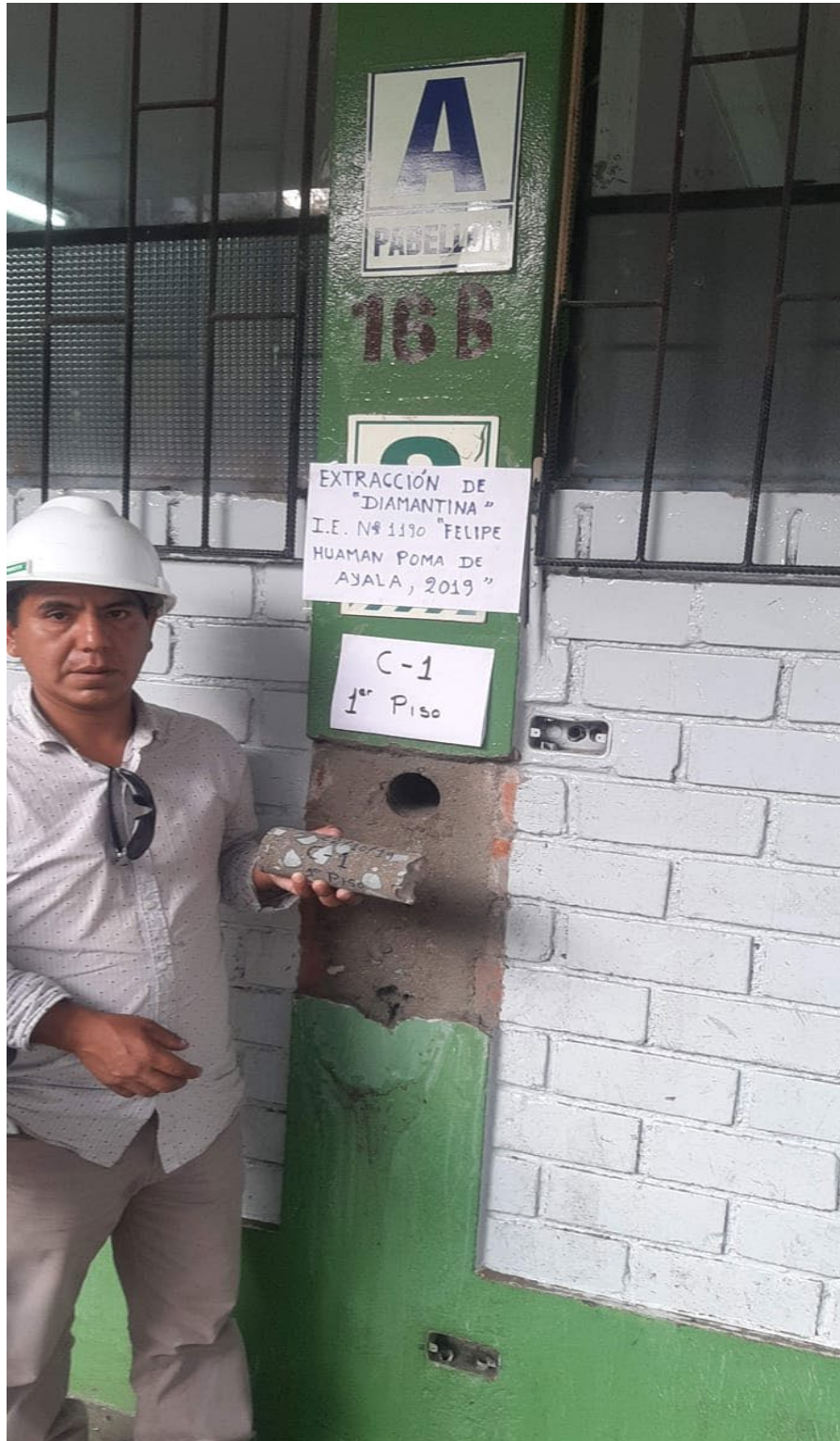
Figura 18. Corazón diamantino de columna 1 primer piso.
