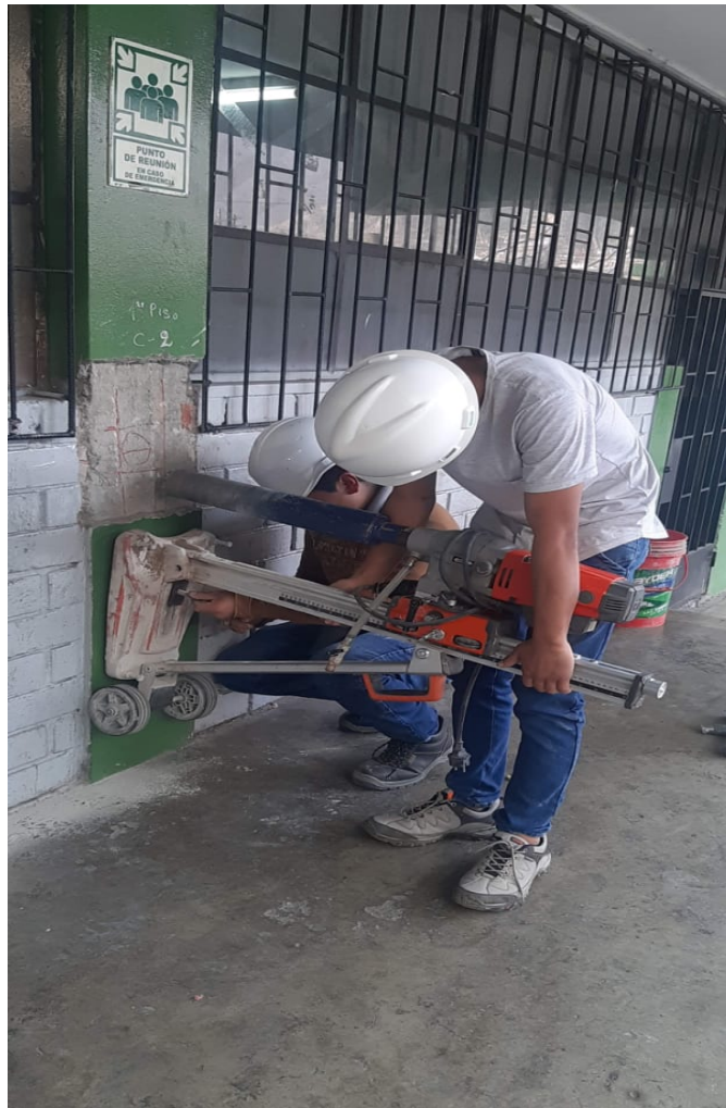
Figura 17. Extracción de corazón diamantino.
