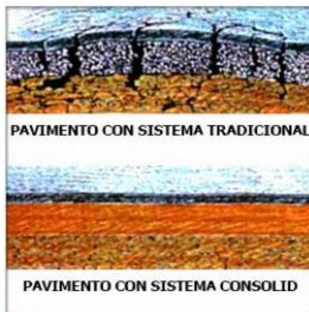
**Figura 9 Estructura del pavimento**
