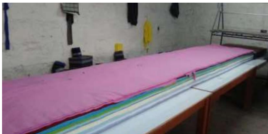
Figura 50. Extendido de telas. Recuperado de: Tapia, Arce y Martínez, 2019
