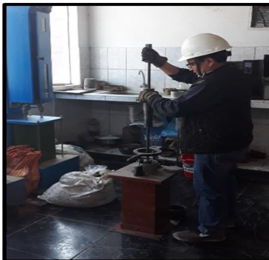
Figura 35. Compactación de la mezcla asfáltica modificada con equipo Marshall.
