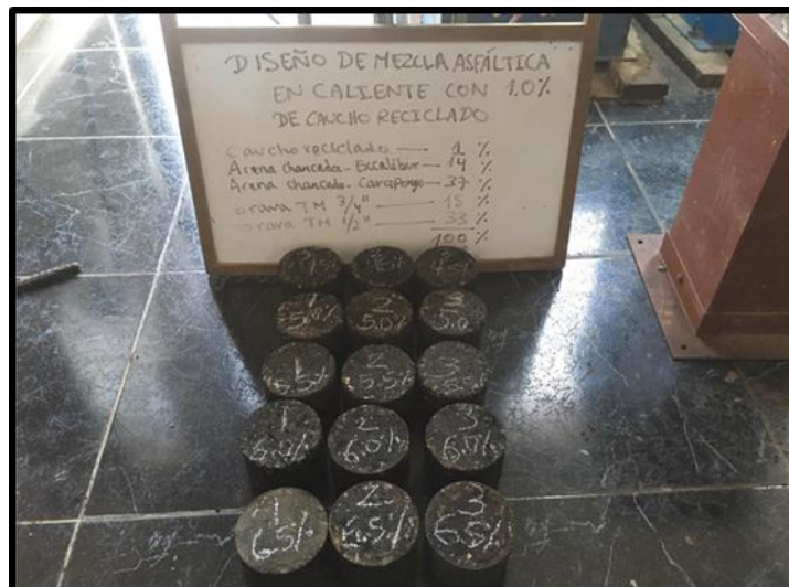
Figura 37. Testigos de asfalto con distintos % de asfalto modificado con C.R. al 1%.
