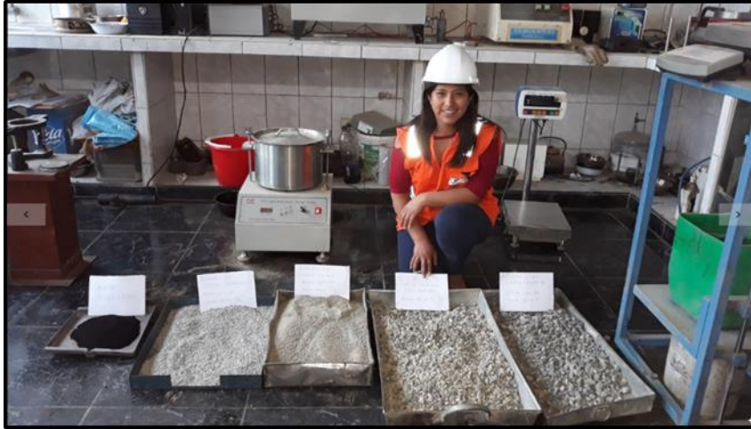
Figura 11. Agregados para la mezcla asfáltica modificada con caucho reciclado.
