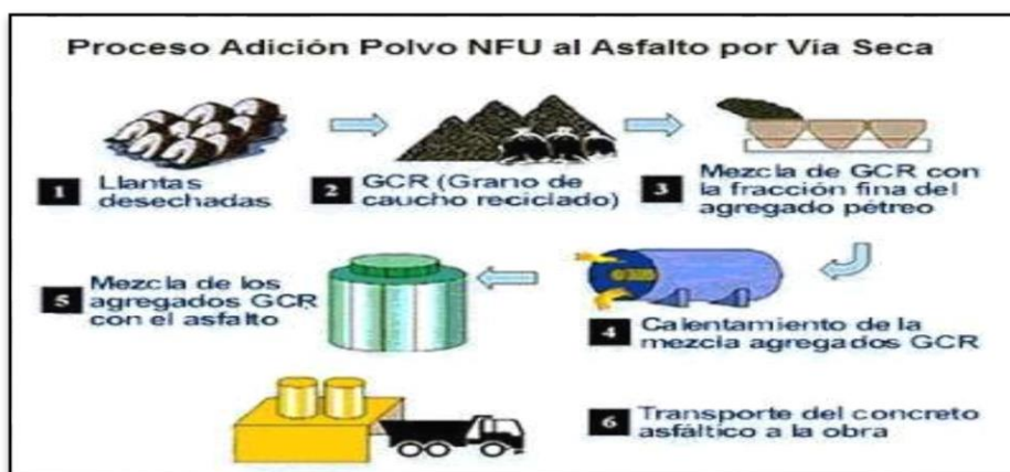
Figura 5. Proceso de fabricación por vía seca.
