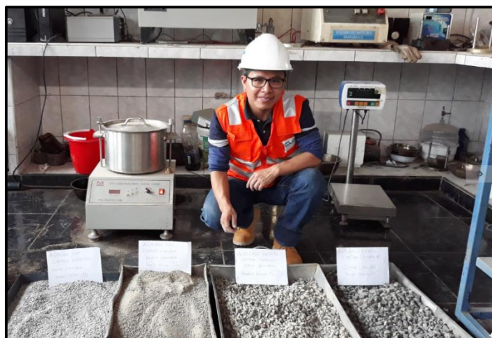
Figura 10. Agregados para mezcla asfáltica convencional Cantera Carapongo – Excalibur.
