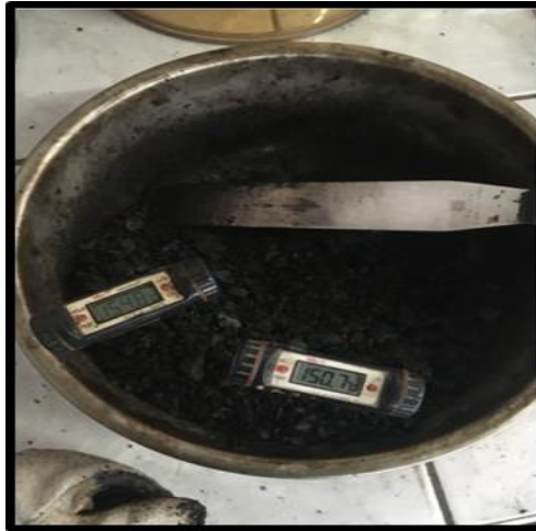
Figura 34. Mezcla de los agregados, caucho y cemento asfáltico.
