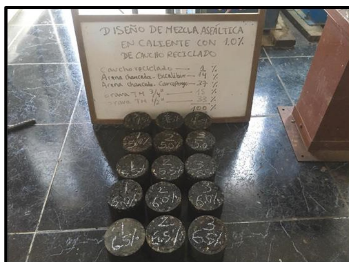
Figura 38. Testigos de asfalto con distintos % de “Asfalto Modificado con C.R.” al 1%.
