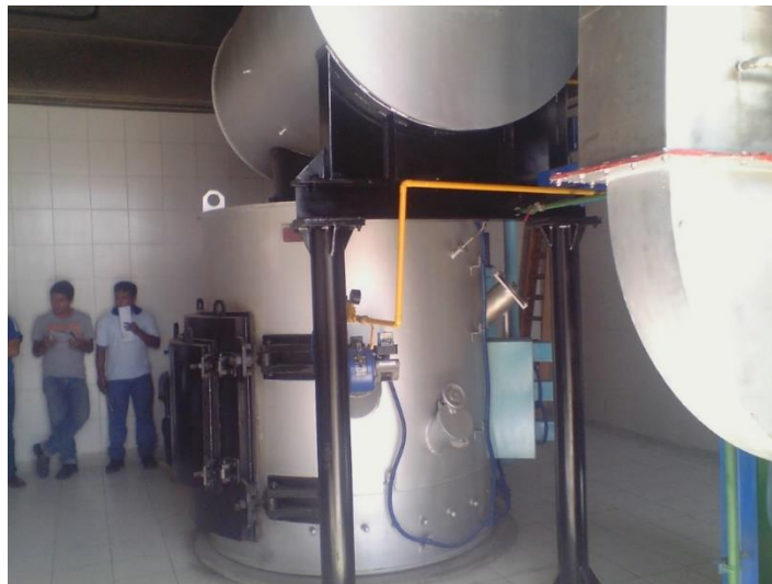
Figura N° 05: Imagen de equipo incinerador pirolítico analizado. Se muestra equipo y personal adiestrado realizando pruebas de medición de gases.
