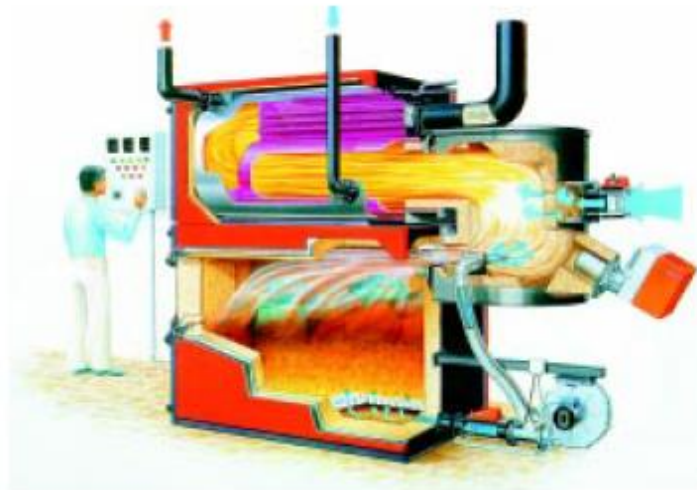
Figura N° 01: Modelo de incinerador de doble cámara convencional. MINSA. (1998).
