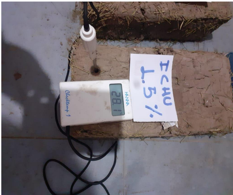
Fotografía 18: ensayos de conductividad térmica con adición 1.5%
