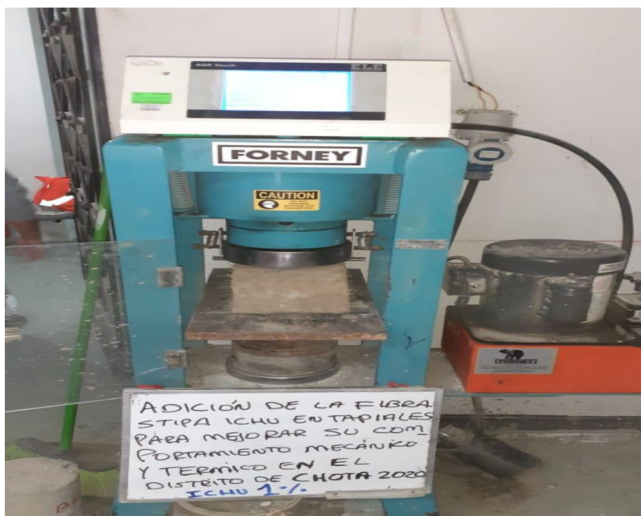
Fotografía 14 Resumen ensayos de resistencia a compresión
