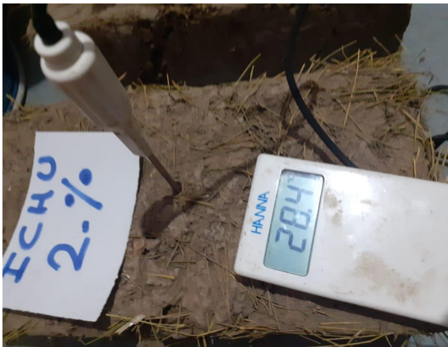
Fotografía 18: ensayos de conductividad térmica con adición 2%
