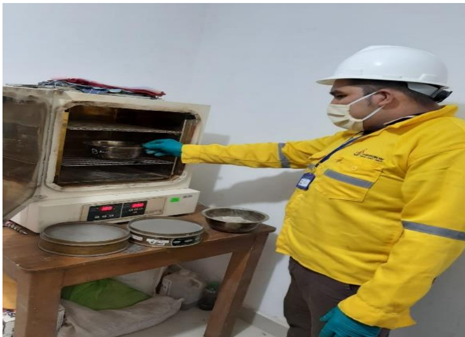
Fotografía 04: Identificación del contenido de humedad
