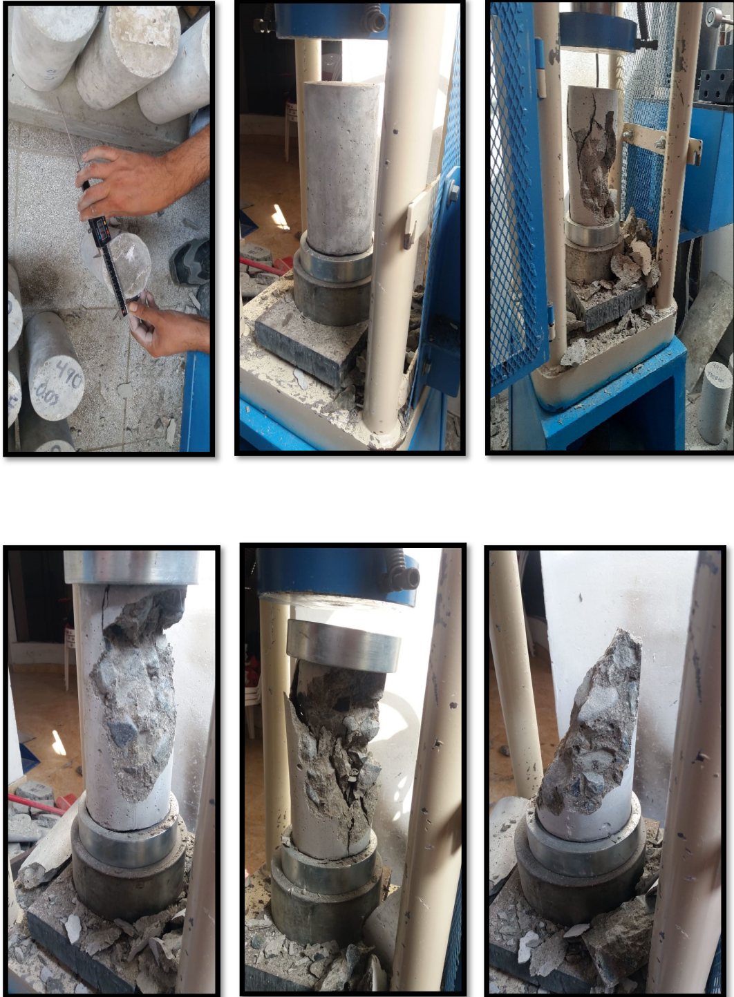
Figura 27. Rotura de probetas para medir la resistencia del concreto
