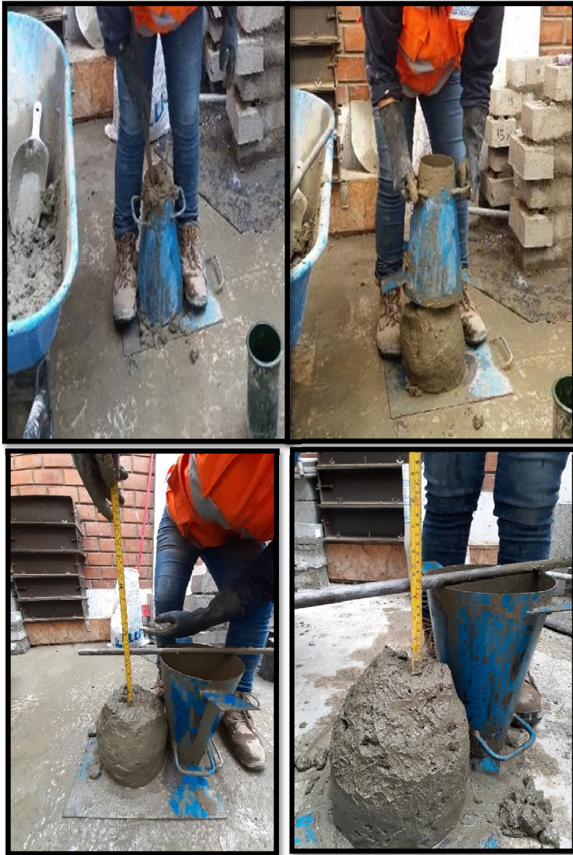
Figura 25 Medición De Slump
