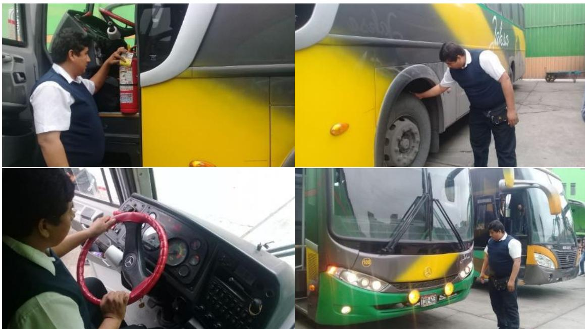
*Figura 26.* Inspección y check-list del bus
