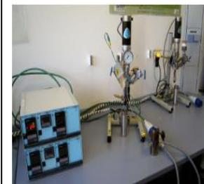
Reactores, con sistema de filtración
