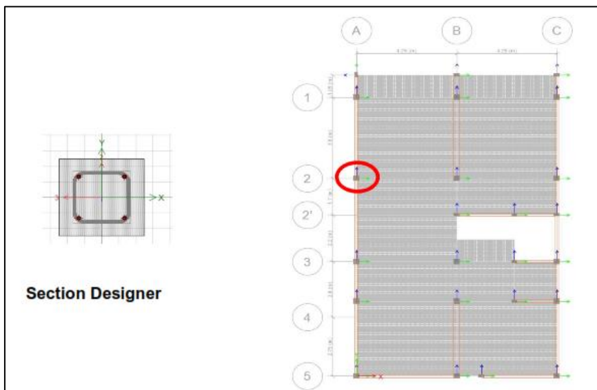
Figura 18 Sección y ubicación de columnas analizadas
