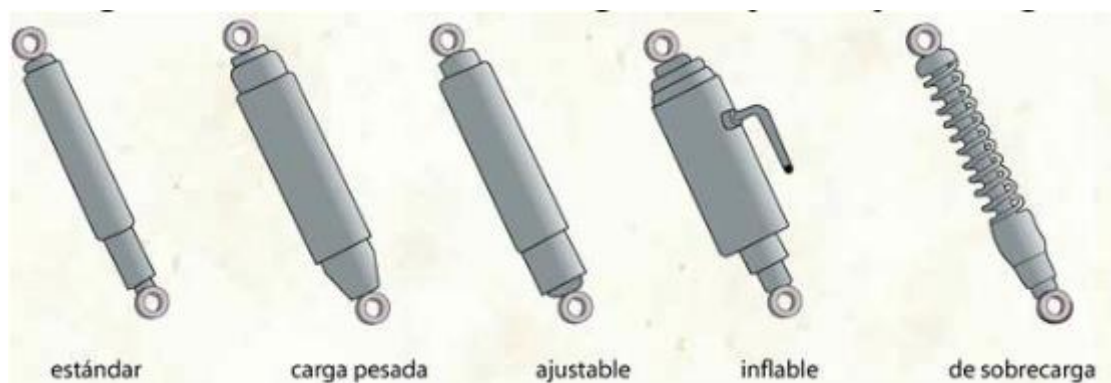
Figura 6.- Clasificación de amortiguadores por el tipo de carga. Fuente:
