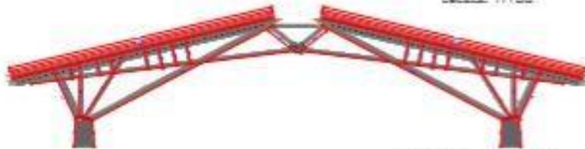
ELEVACIÓN DE ESTRUCTURA: AMARRE VIGA-COLUMNA PÓRICO 2 ESCALA: 1/100
