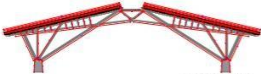
ELEVACIÓN DE ESTRUCTURA: AMARRE VIGA-COLUMNA PÓRICO 1 ESCALA: 1/100
