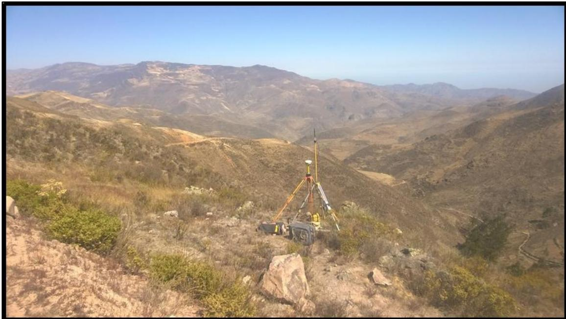
Fotografía 4: Punto base referenciado con gps diferencia de tiempo real para incios de trabajos del estudio topográfico
