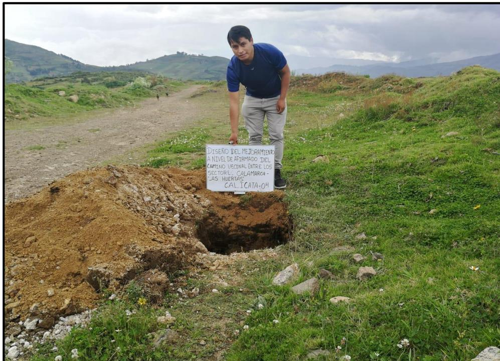
Fotografía 10: Recolección de muestras de la vía existente C2 para el estudio de mecánica de suelos
