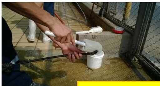
Limpieza de los Filtros de la Bomba
