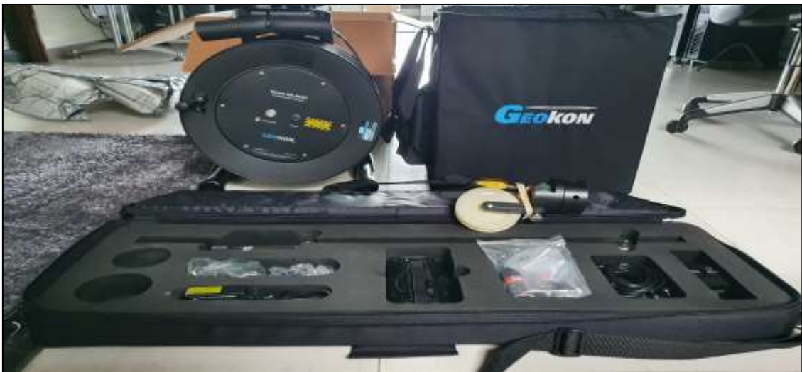
Figura N° 21: Equipo Inclinométrico completo para la recolección de Información marca GEOKON
