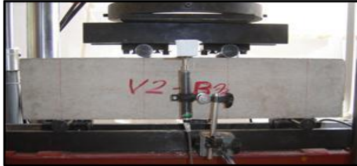
Figura 10. Ensayo de resistencia a la flexión del concreto
