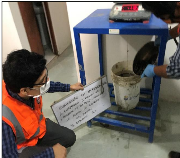
Ensayo del peso específico y absorción del agregado fino Fuente: propia
