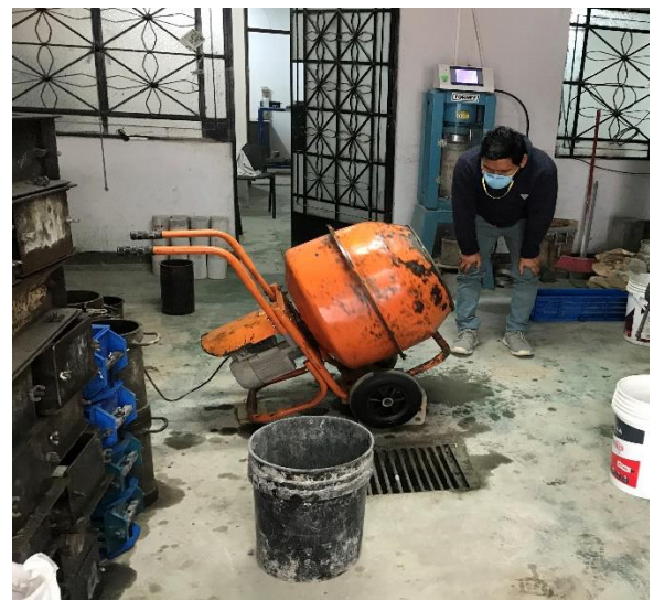
Mezclado de los agregados Fuente: propia
