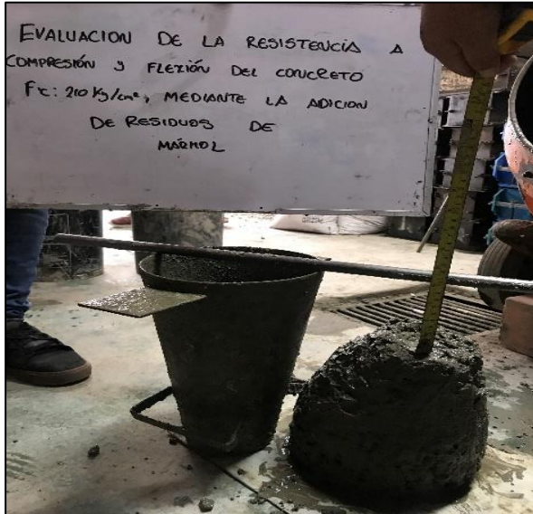
Slump - mezcla patrón Fuente: propia
