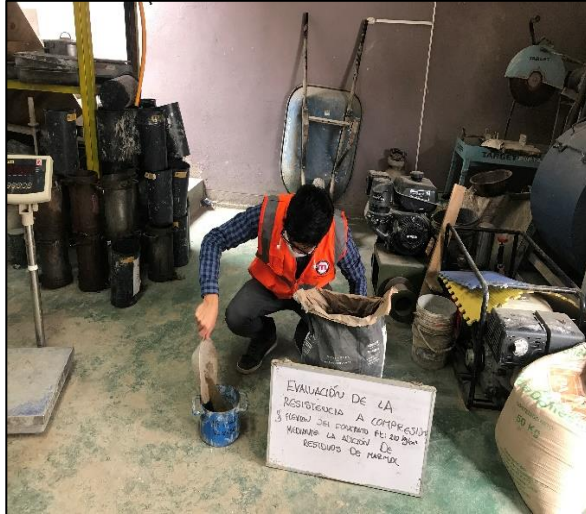
Ensayo de peso unitario suelto del agregado fino Fuente: propia
