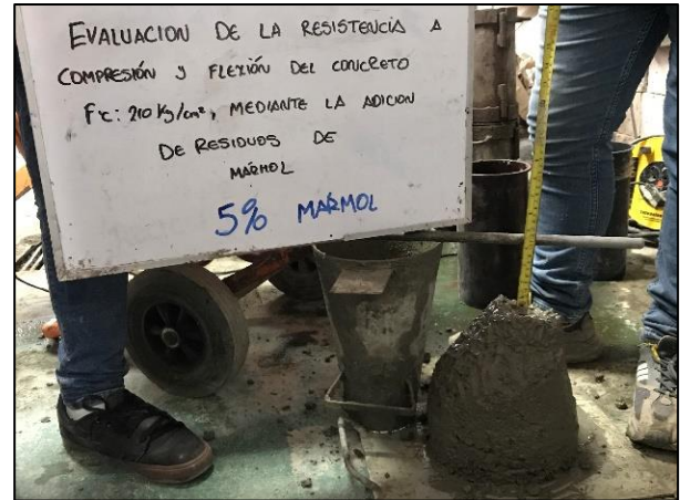
Slump - mezcla 5% residuos de mármol Fuente: propia
