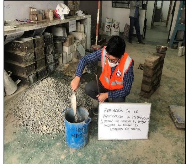
Ensayo de peso unitario suelto del agregado grueso Fuente: propia
