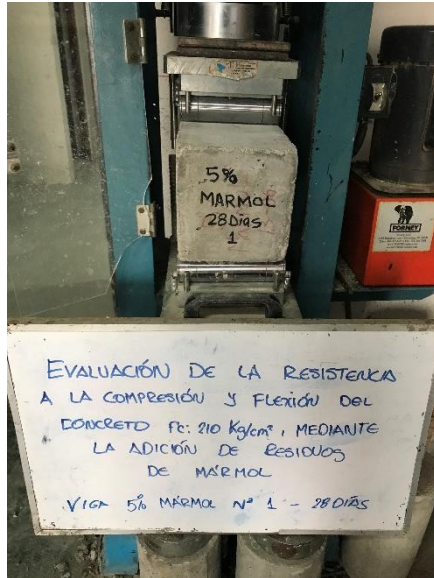
Rotura de viga 5% mármol – 28 días Fuente: propia
