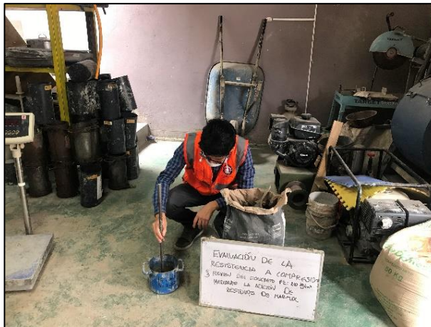
Ensayo de peso unitario compactado del agregado fino Fuente: propia
