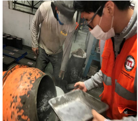
Vertido de los residuos de mármol en la mezcladora Fuente: propia
