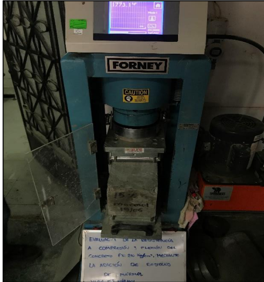
Rotura de viga 15% mármol – 7 días Fuente: propia
