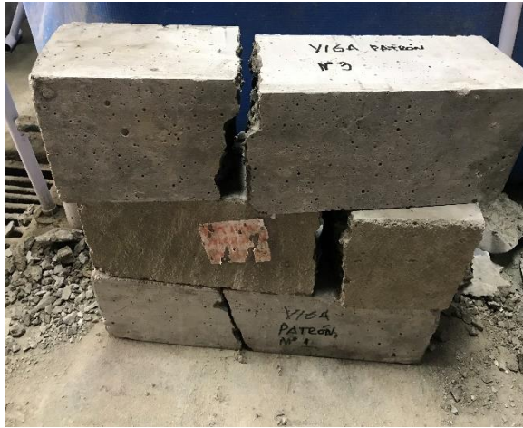
Rotura de viga patrón – 14 días Fuente: propia
