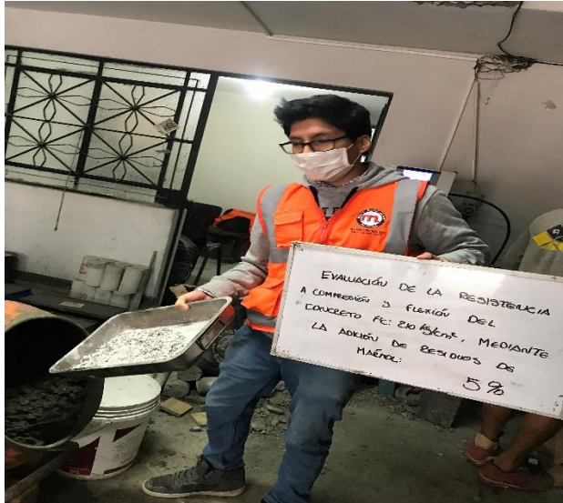
Vertido de los residuos de mármol en la mezcladora Fuente: propia
