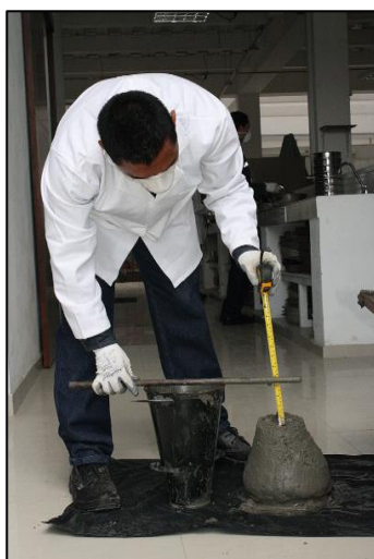
Figura 5. Ensayo de consistencia del concreto
