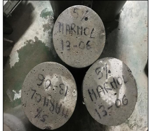
Rotura de probeta 5% mármol - 7 días Fuente: propia
