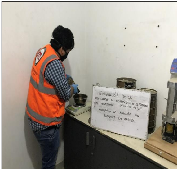
Ensayo granulométrico de los agregados Fuente: propia
