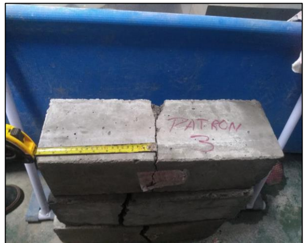
Rotura de viga patrón - 7 días
