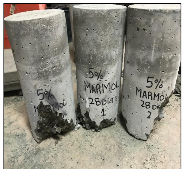
Rotura de probeta 5% mármol - 28 días Fuente: propia
