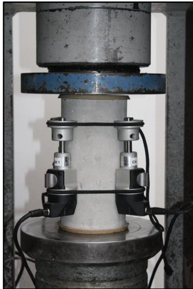
Figura 7. Ensayo de resistencia a la compresión del concreto
