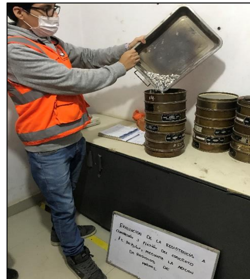
Equipos para el ensayo granulométrico del mármol Fuente: propia
