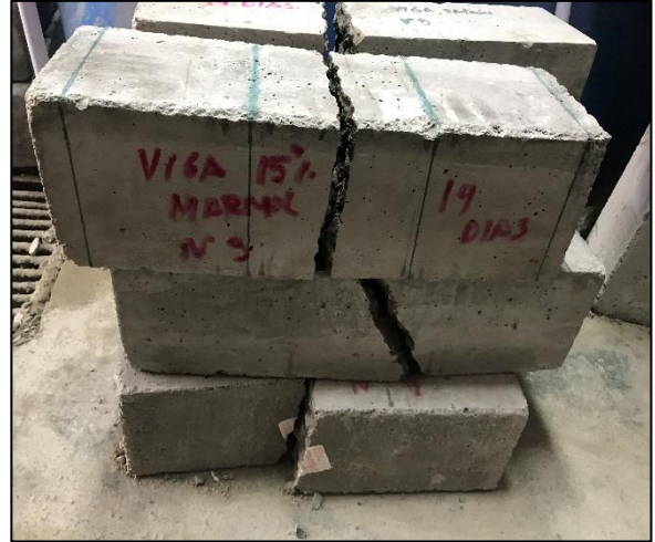
Rotura de viga 15% mármol – 14 días Fuente: propia
