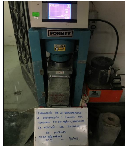
Rotura de viga 10% mármol – 7 días Fuente: propia
