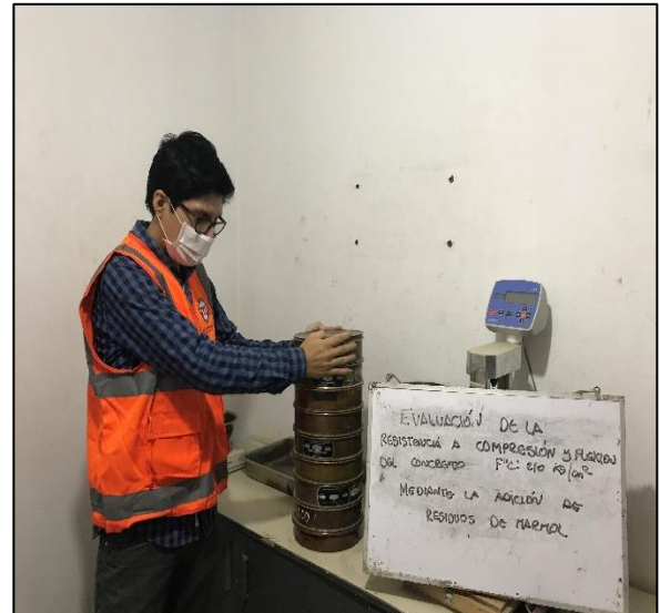
Ensayo granulométrico de los agregados Fuente: propia
