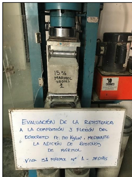
Rotura de viga 15% mármol – 28 días Fuente: propia
