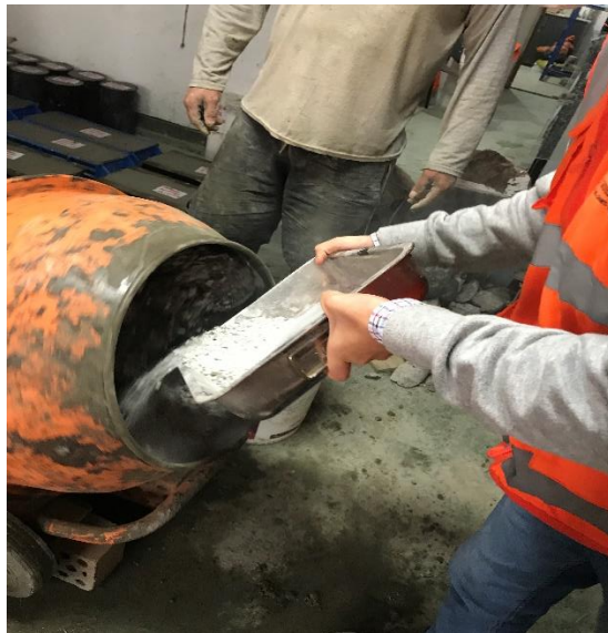
Vertido de los residuos de mármol en la mezcladora Fuente: propia
