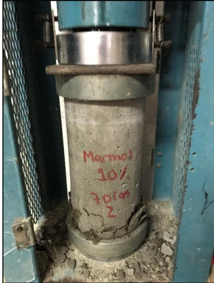
Rotura de probeta 10% mármol - 7 días Fuente: propia
