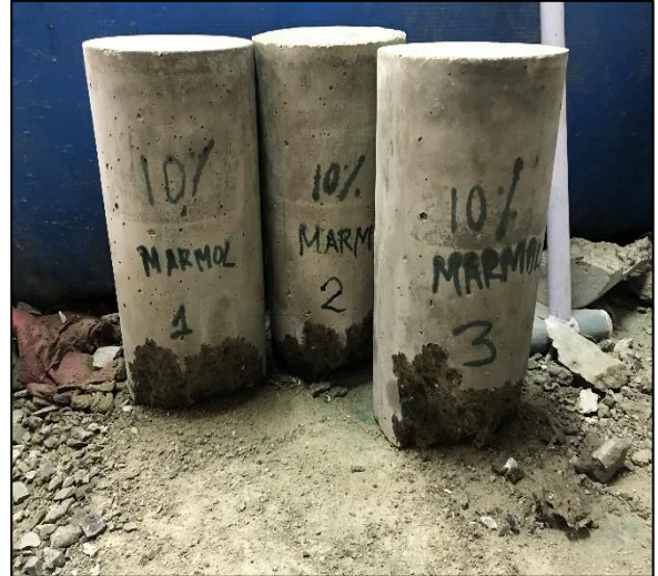
Rotura de probeta 10% mármol - 14 días Fuente: propia
