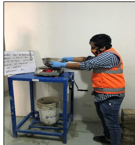
Ensayo del peso específico y absorción del agregado grueso Fuente: propia
