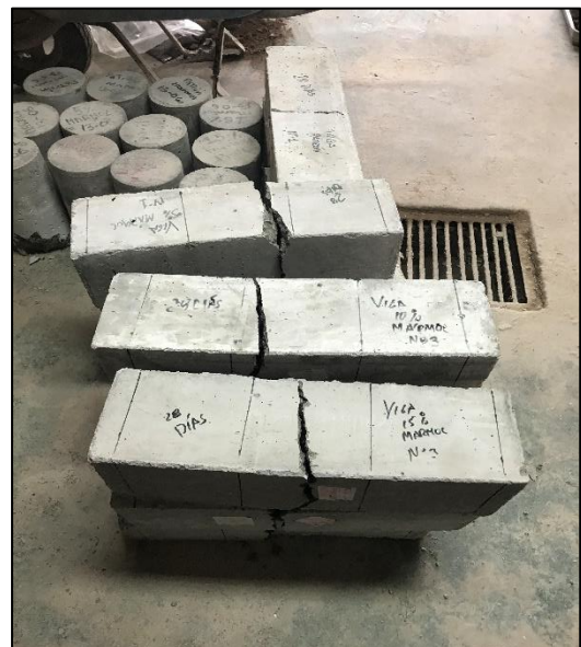
Rotura de vigas Fuente: propia
