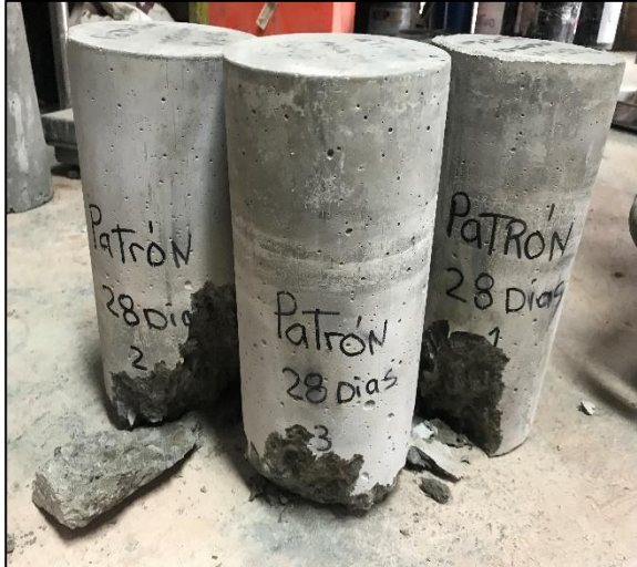
Rotura de probeta patrón - 28 días Fuente: propia
