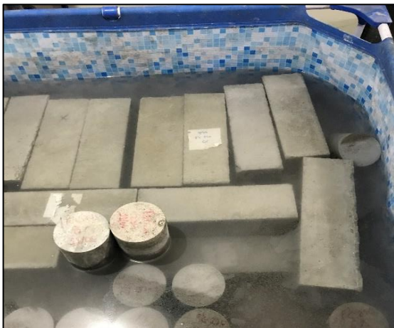
Curado de vigas
