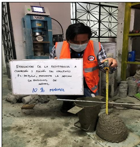
Slump - mezcla 10% residuos de mármol Fuente: propia
