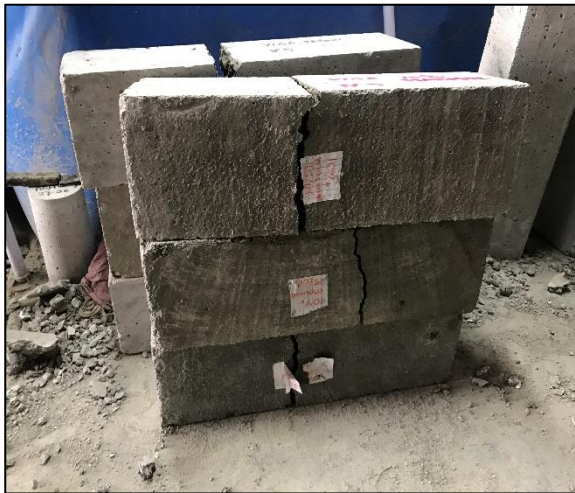
Rotura de viga 10% mármol – 14 días Fuente: propia
