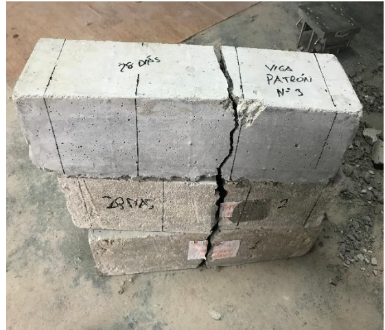
Rotura de viga patrón – 28 días Fuente: propia
