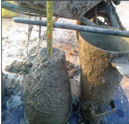
Figura 6. Medición del asentamiento
