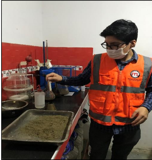
Ensayo del peso específico y absorción del agregado fino Fuente: propia
