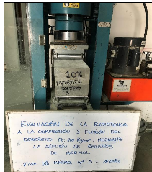
Rotura de viga 10% mármol – 28 días Fuente: propia
