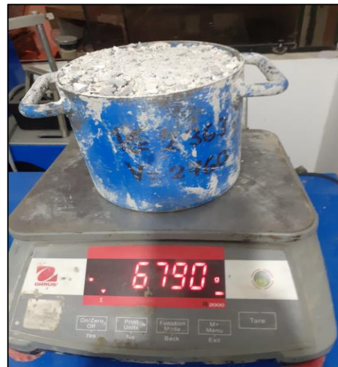
Ensayo de peso unitario compactado del mármol triturado Fuente: propia
