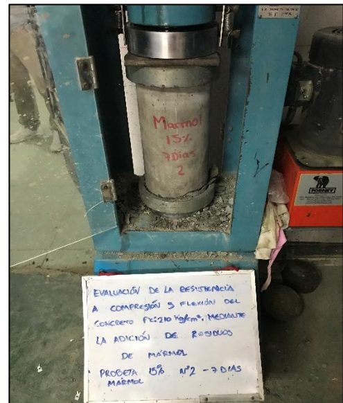
Rotura de probeta 15% mármol - 7 días Fuente: propia
