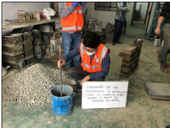
Ensayo de peso unitario compactado del agregado grueso Fuente: propia
