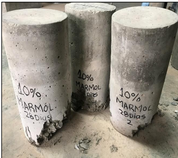
Rotura de probeta 10% mármol - 28 días Fuente: propia
