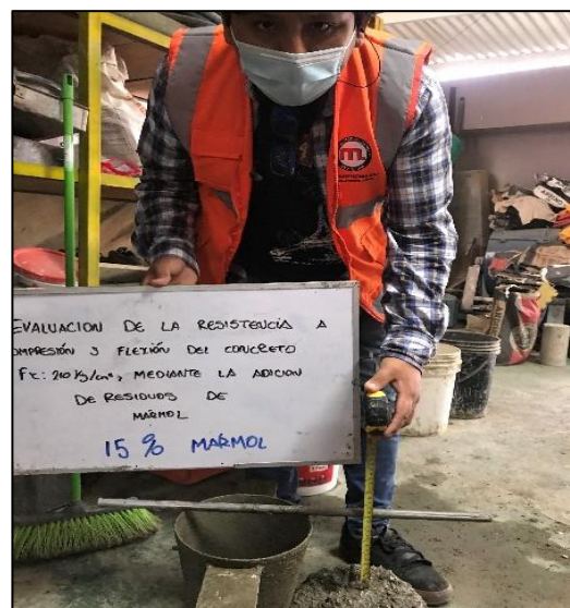
Slump - mezcla 15% residuos de mármol Fuente: propia
