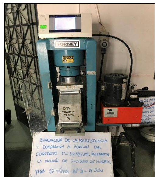
Rotura de viga 5% mármol – 14 días Fuente: propia
