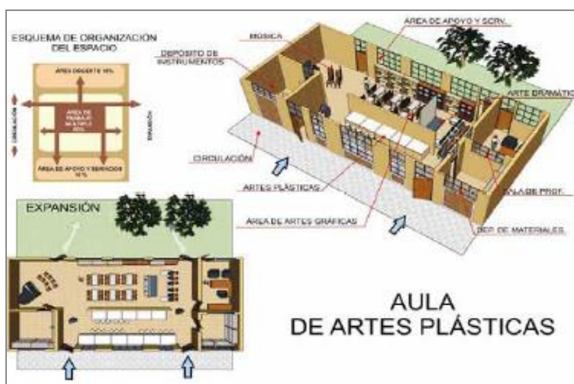
Figura 93: Planta fugada e Isométrico y Esquema de organización de aulas de Artes Plásticas. Fuente: MINEDU (2006). Normas Técnicas para el diseño de locales de educación básica especial y programas de Intervención temprana. Perú: Ministerio de Educación.
