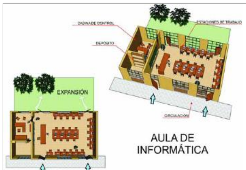
Figura 89: Planta fugada e Isométrico de Sala de Cómputo. Fuente: MINEDU (2006). Normas Técnicas para el diseño de locales de educación básica especial y programas de Intervención temprana. Perú: Ministerio de Educación.
