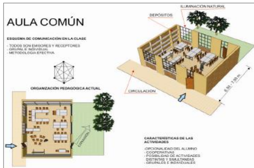
Figura 87: Planta fugada e Isometría de un Aula Común. Fuente: MINEDU (2006). Normas Técnicas para el diseño de locales de educación básica especial y programas de Intervención temprana. Perú: Ministerio de Educación.
