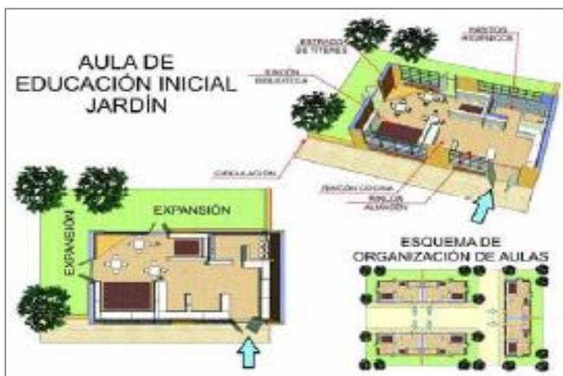
Figura 91: Planta fugada e Isométrico y Esquema de organización de aulas de educación Inicial - Jardín. Fuente: MINEDU (2006). Normas Técnicas para el diseño de locales de educación básica especial y programas de Intervención temprana. Perú: Ministerio de Educación.
