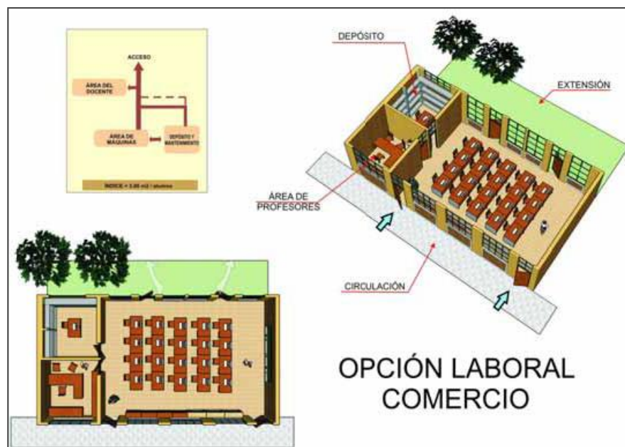
Figura 116: Planta fugada e Isométrico y Esquema de organización del taller de Opción Laboral Comercio. Fuente: MINEDU (2006). Normas Técnicas para el diseño de locales de educación básica especial y programas de Intervención temprana. Perú: Ministerio de Educación.
