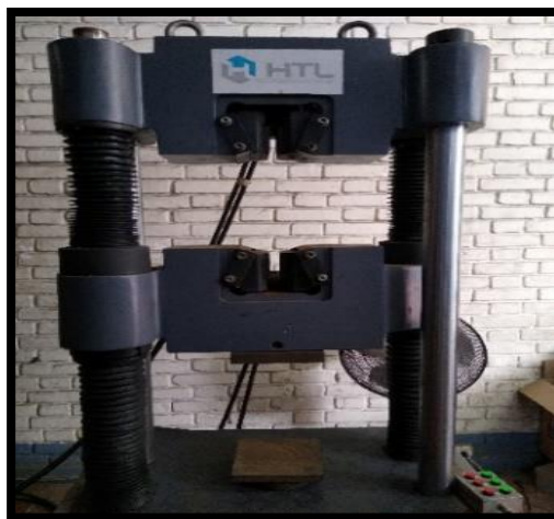
Figura 10: Máquina de ensayo a compresión Fuente: Propia
