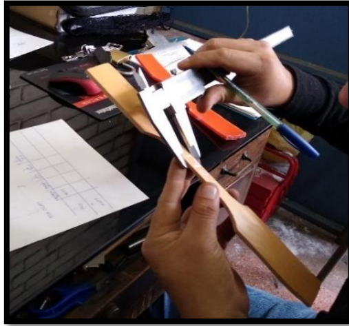
Figura 27: Toma de medidas de probeta Fuente: Propia
