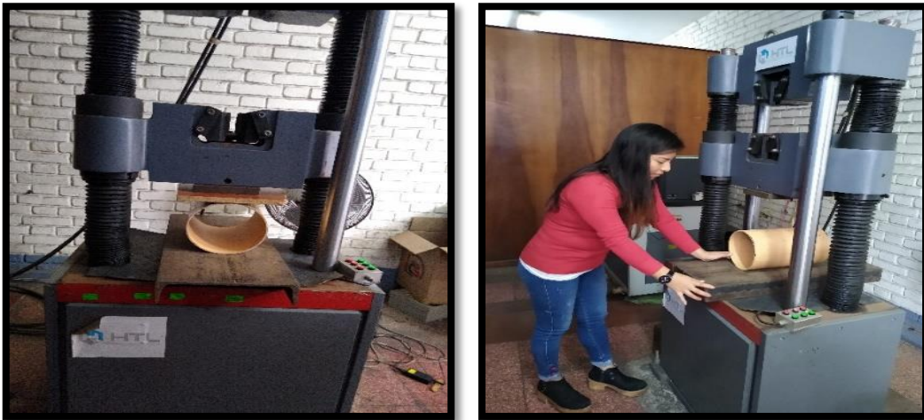
Figura 13: Ensayo con maquina a compresión en tubería de PVC Fuente: Propia
