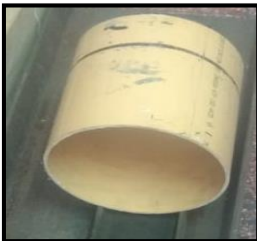
Figura 23: Probeta con 12 líneas equidistantes Fuente: Propia
