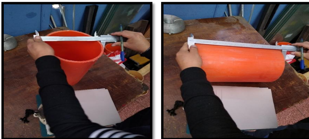
Figura 12: Toma de medida de diámetros en tubería de HDPE Fuente: Propia
