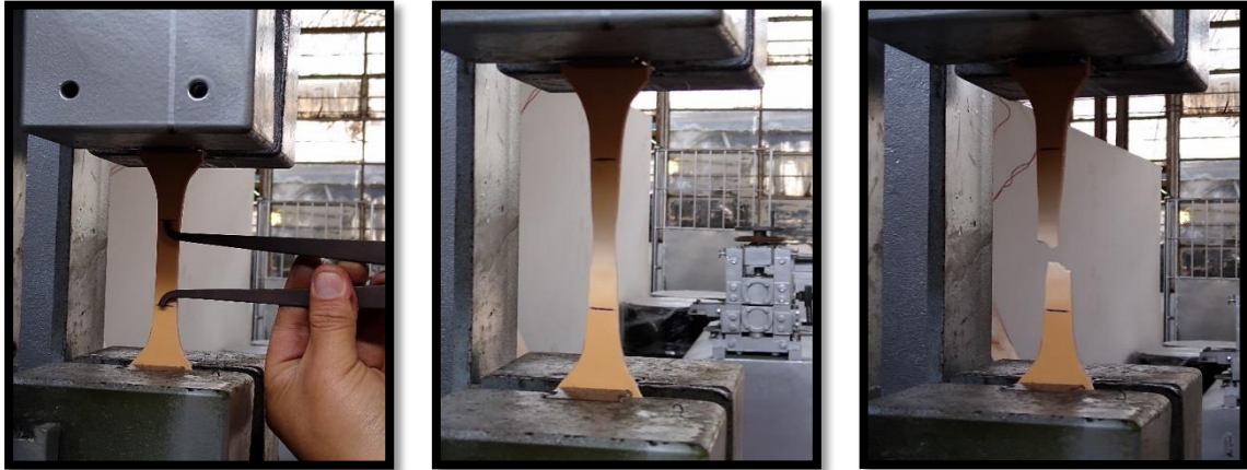
Figura 36: Probetas de PVC en proceso a la ruptura Fuente: Propia
