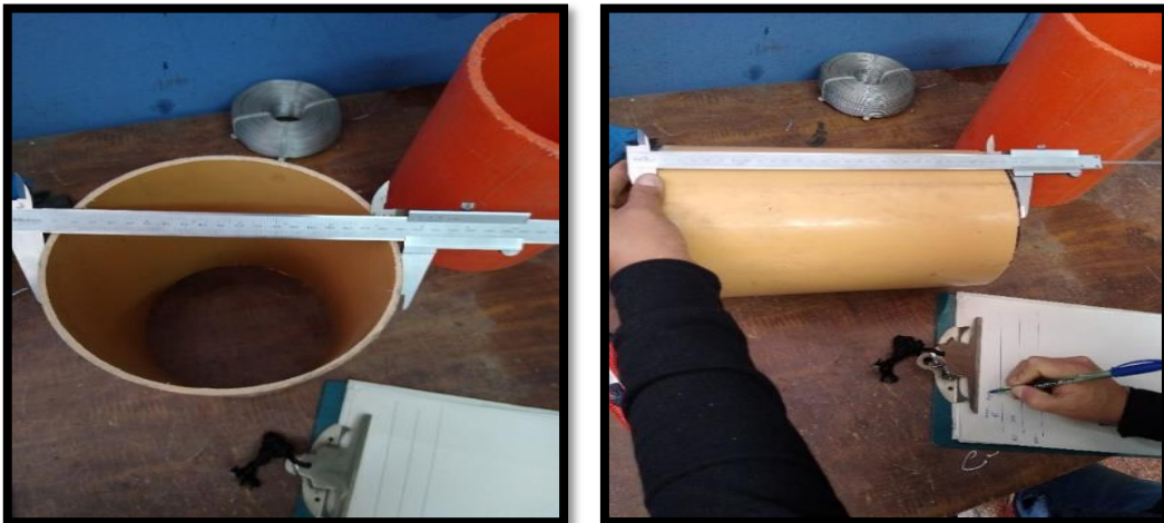
Figura 11: Toma de medida de diámetros en tubería de PVC Fuente: Propia
