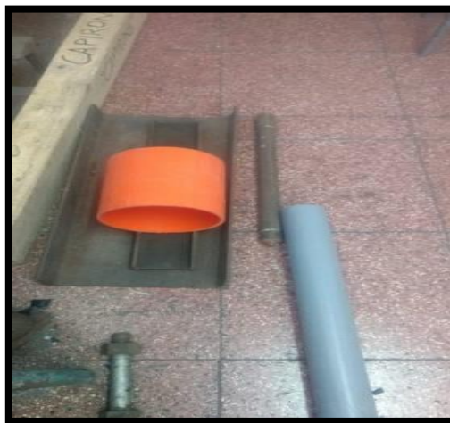
Figura 17: Probeta de HDPE y herramientas para ensayo Fuente: Propia
