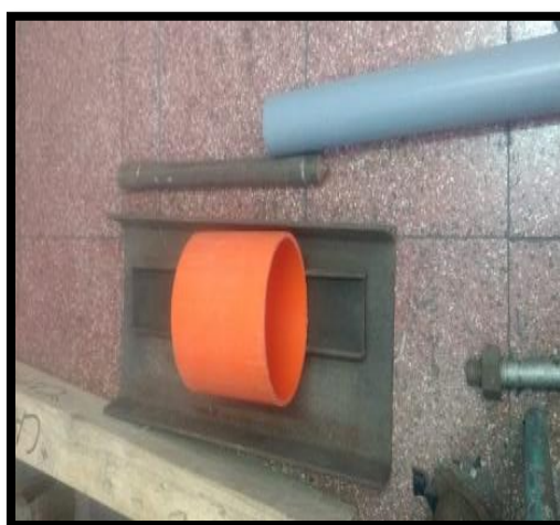
Figura 22: Probeta, Base de soporte y Percutor Fuente: Propia
