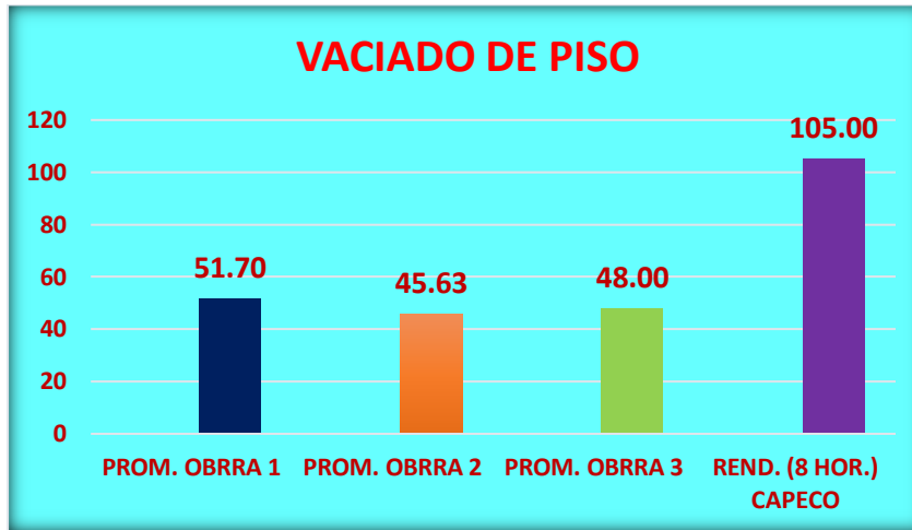
Ilustración 19. Comparación promedio vs CAPECO, vaciado de piso.
