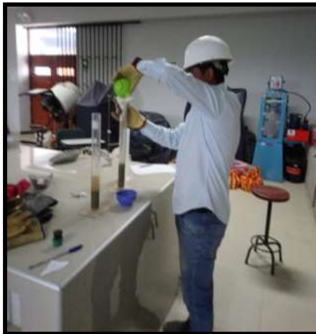
Imagen N° 13. Introducción de 200 gr de agregado fino.
