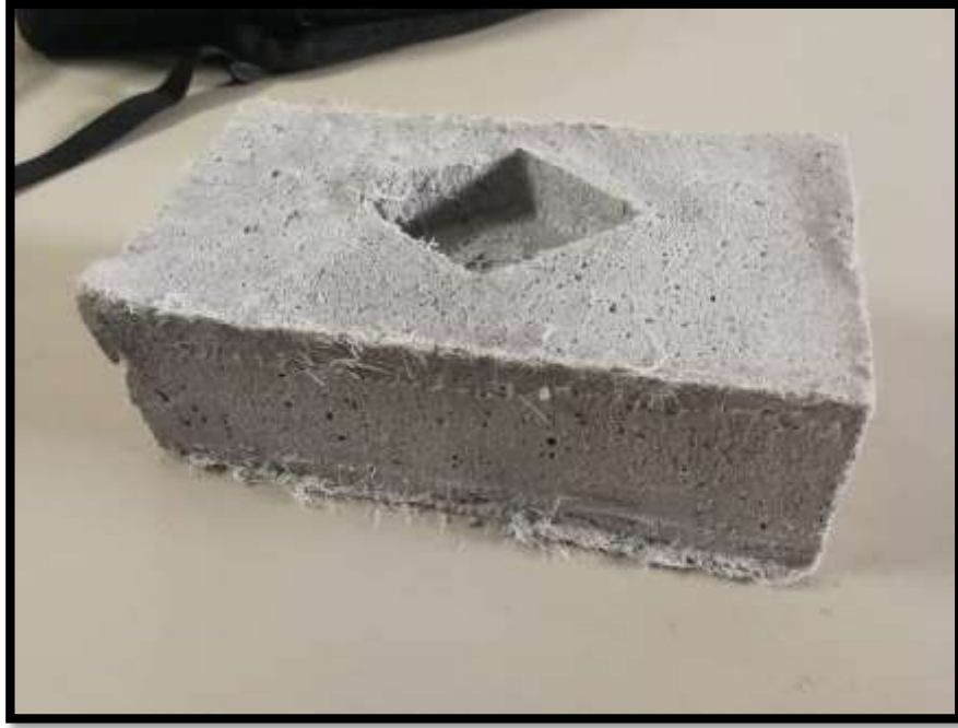
Imagen N° 25. Bloque de concreto celular con 0.30% de fibra sintética en relación al cemento.
