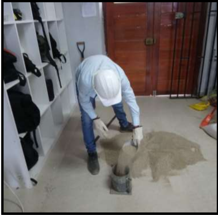
Imagen N° 7. Primera muestra para el peso del agregado fino
