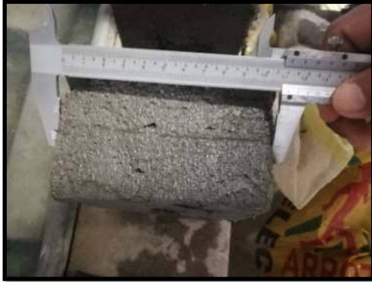
Imagen N° 23. Se toma las dimensiones de los bloques para el caculo de resistencia a compresión.
