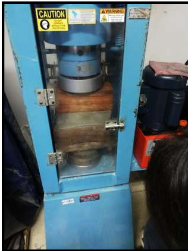
Imagen N° 24. Rotura de bloques de concreto celular con fibra sintética a los 21 días.
