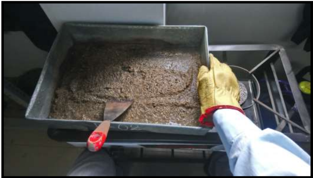
Imagen N° 11. Lavado y pesado de 500g. del material para el ensayo.
