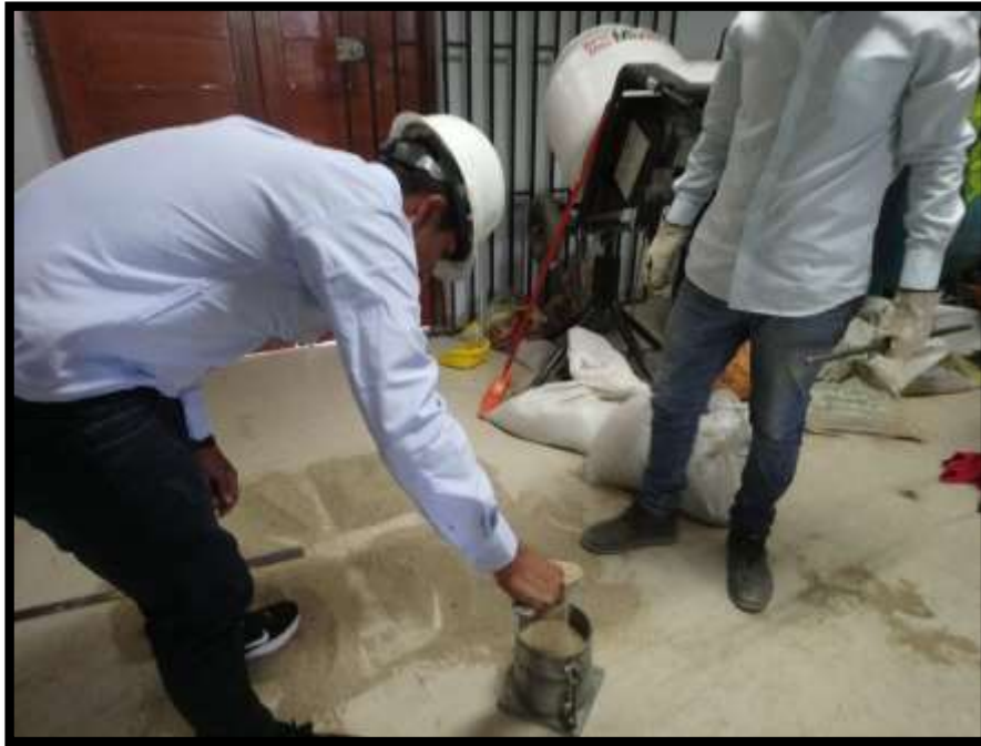
Imagen N° 9. Cuarteo del agregado fino, utilizamos dos extremos.
