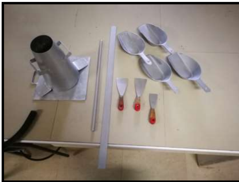
Imagen N° 16. Equipos usados para la mezcla de los materiales y el ensayo de asentamiento.
