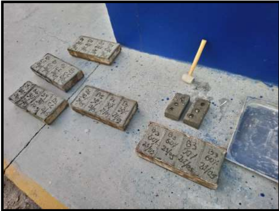
Imagen N° 20. Moldes con bloques de concreto celular con las diferentes dosificaciones de fibra sintética.
