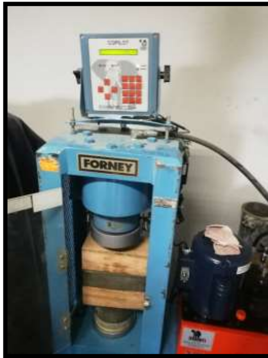
Imagen N° 21. Rotura de bloques a los 14 días.
