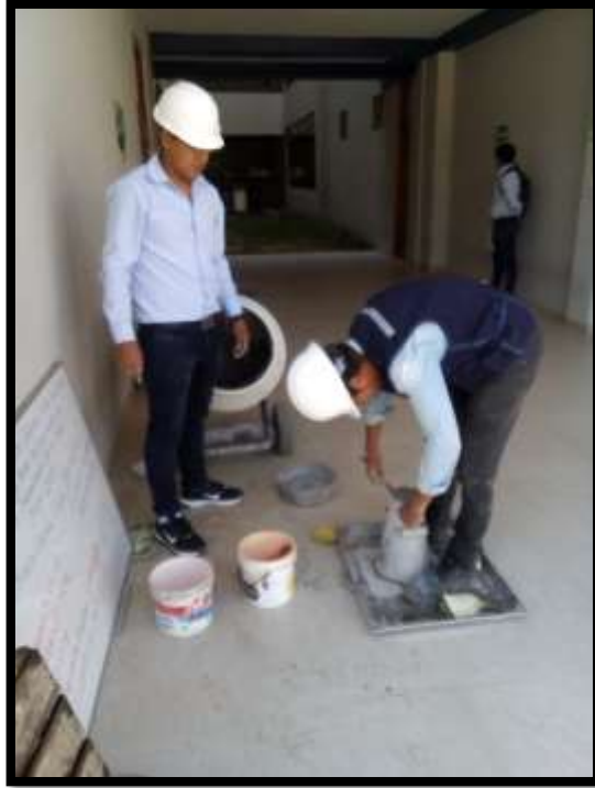
Imagen N° 19. Ensayo del Slump.
