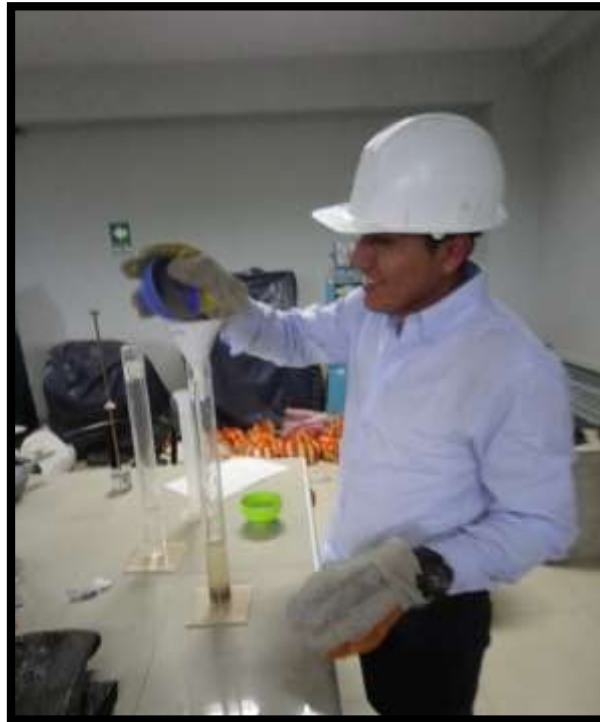
Imagen N° 13. Introducción de 200 gr de agregado fino.
