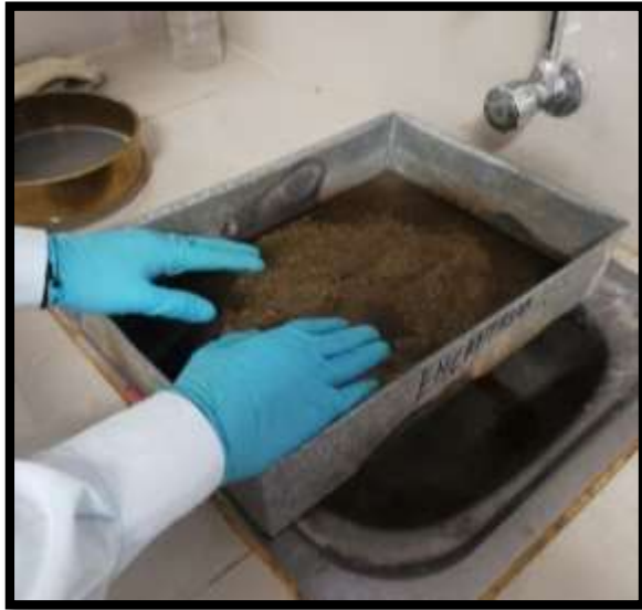
Imagen N° 3. Lavado del material con el tamiz N° 200.
