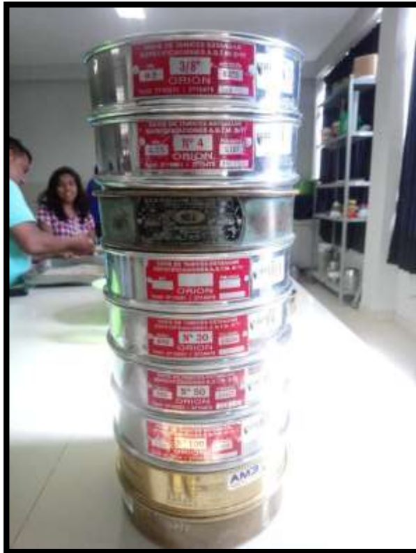
Imagen N° 3. Lavado del material con el tamiz N° 200.
