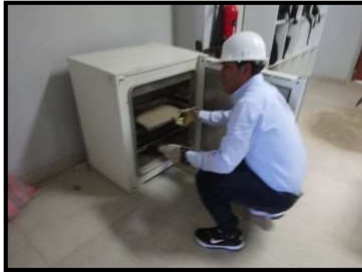
Imagen N° 5. Introducción de la muestra en el horno.
