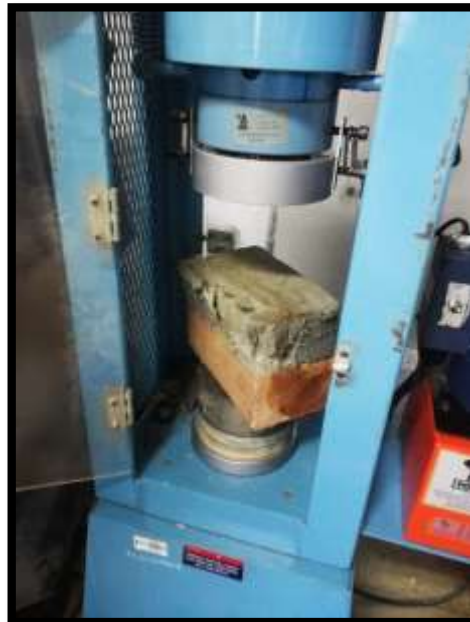
Imagen N° 22. Bloque sometido a compresión para la determinación de su resistencia.
