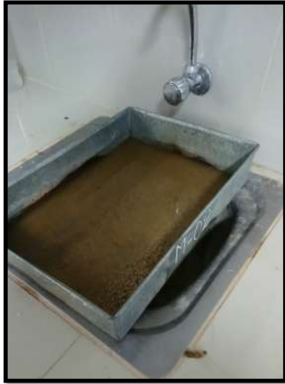
Imagen N° 11. Lavado y pesado de 500g. del material para el ensayo.
