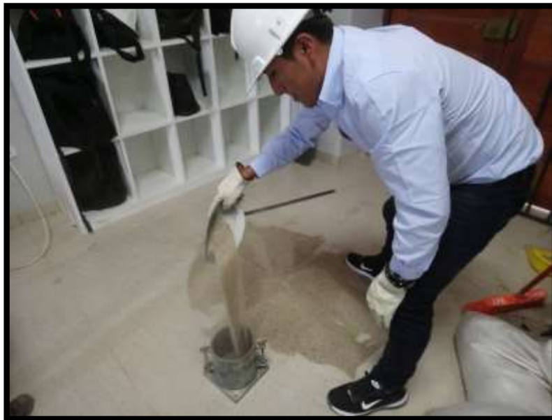
Imagen N° 7. Primera muestra para el peso del agregado fino
