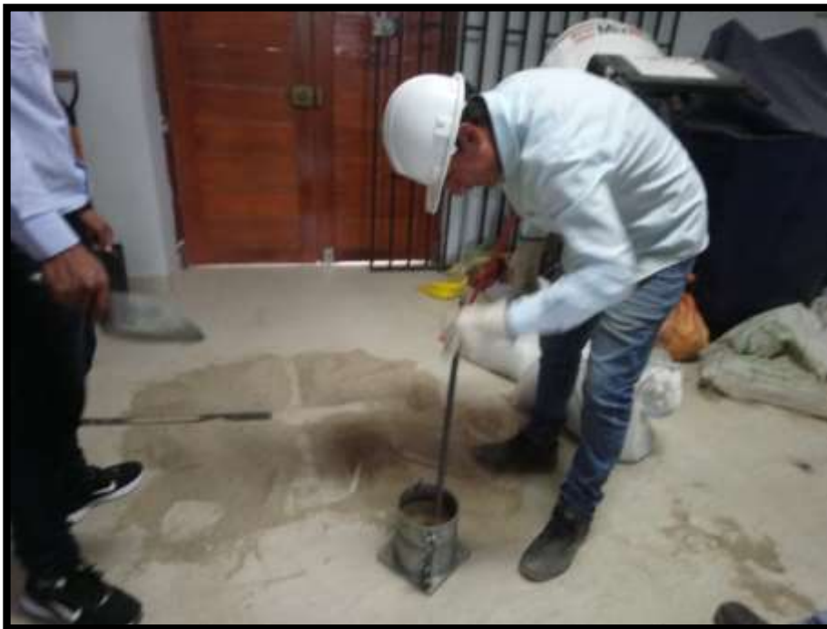
Imagen N° 9. Cuarteo del agregado fino, utilizamos dos extremos.
