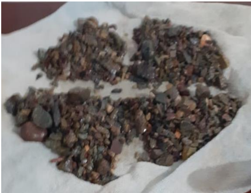
ANEXO 12: Método de cuarteo de material grueso
