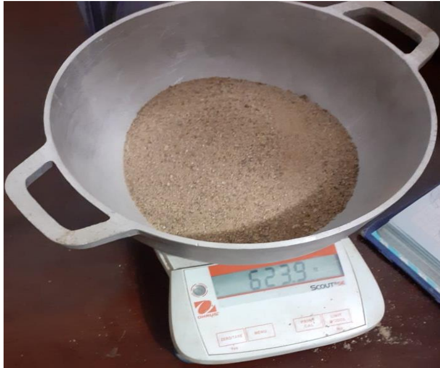
ANEXO 9: Peso seco del material fino
