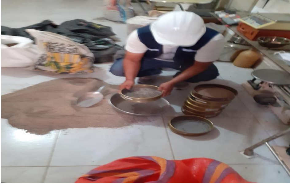
ANEXO 6: Proceso de tamizado del material fino
