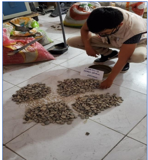
FIGURA 12: Para el siguiente diseño se realizó el cuarteo del agregado grueso, separándolo igualmente en 4 partes iguales, tomando así 1 parte para ser estudiada.
