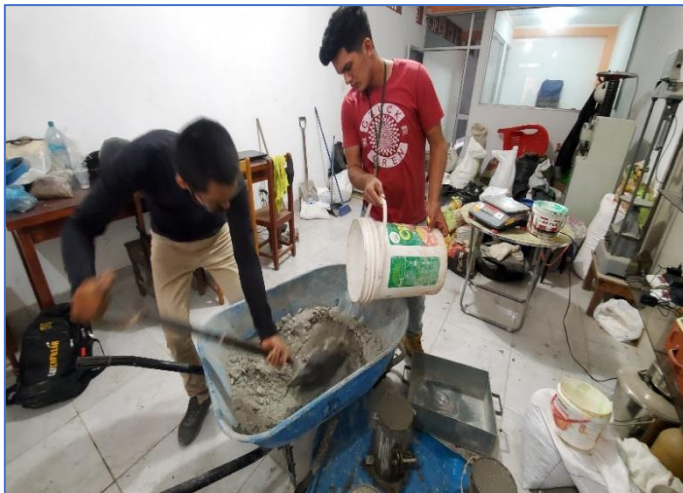
FIGURA 24: Se realizó el proceso de mezclado de los materiales de acuerdo a los porcentajes establecidos por el laboratorista.
