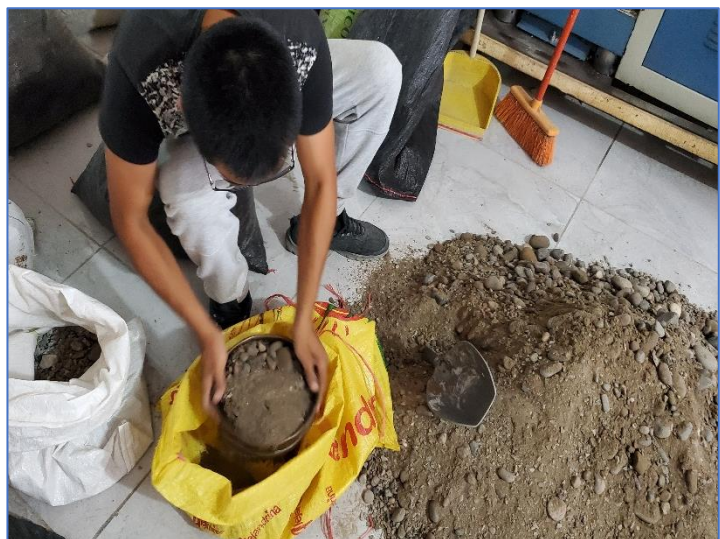
FIGURA 22: Se realizó el proceso de zarandeo del agregado fino mezclado con piedra.
