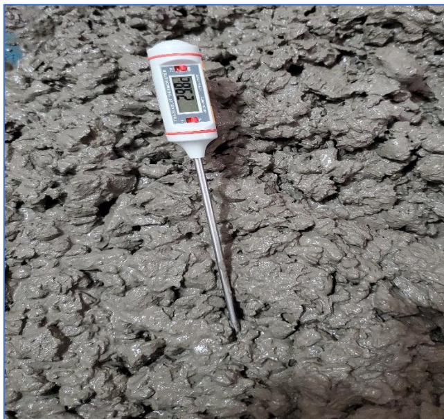
FIGURA 28: Tomado de temperatura a la mezcla de concreto para tomar como referencia que no debe excederse de los parámetros establecidos.
