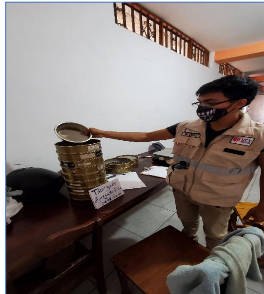
FIGURA 14: Se procedió a realizar el tamizaje del agregado fino desde el tamiz 3/8" hasta el tamiz 200" véase también la FIGURA 15.
