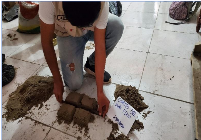
FIGURA 08: Luego del tamizaje se procedió al cuarteo del agregado fino en 4 partes, separando solo 1 parte para el pesado.
