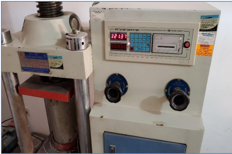
FIGURA 31: Rotura de probetas de concreto a los 7,14 y 28 días, véase en las demás figuras a continuación.
