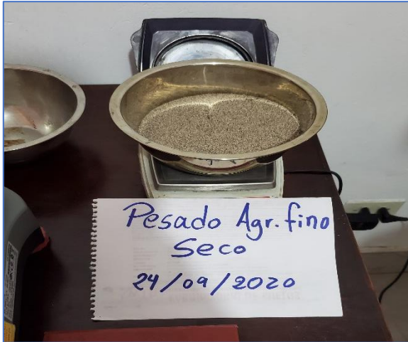
FIGURA 11: Se pesó el agregado fino ya totalmente seco, observando en el valor del peso una diferencia a comparación de cuando el agregado esta con su humedad natural.
