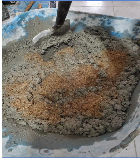
FIGURA 27: Adición de la fibra de Attalea Moorei a la mezcla de concreto para ser vaciado en los moldes de probetas.
