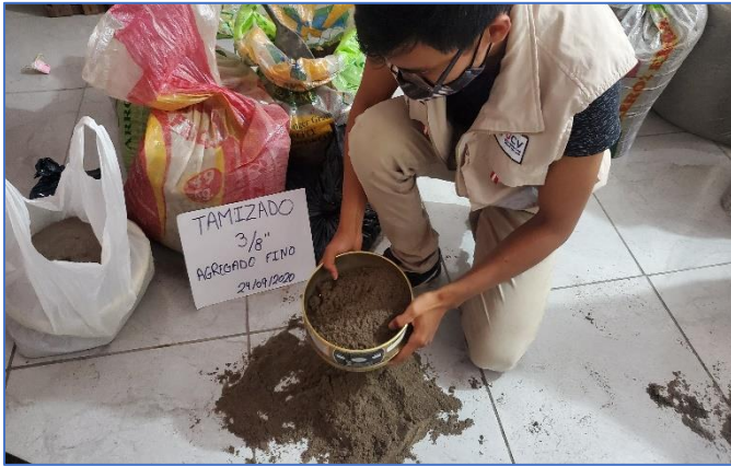
FIGURA 07: Para el diseño, se realizó el tamizado del agregado fino recién sacado de la cantera y pasarlo por el tamiz de 3/8" para una previa limpieza de materiales excedentes.
