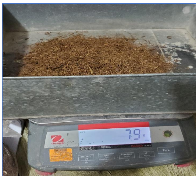
FIGURA 26: Proceso de pesaje de la fibra de Attalea Moorei para el porcentaje de 1%.
