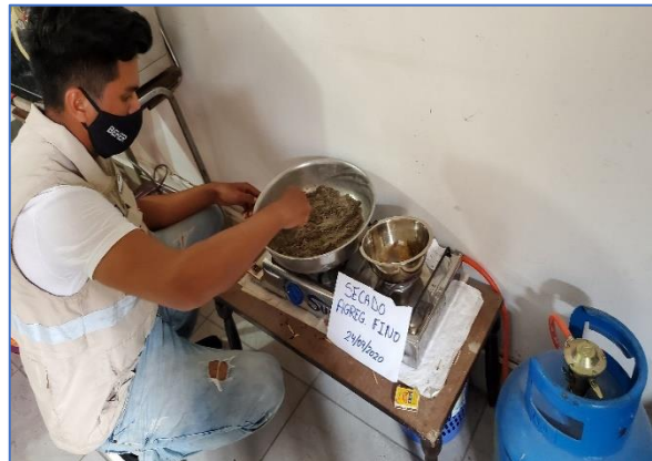
FIGURA 10: Se llevo a cabo el secado del agregado fino en una cocina, para lo cual empleamos un vidrio para saber cuándo se secó el agregado totalmente.
