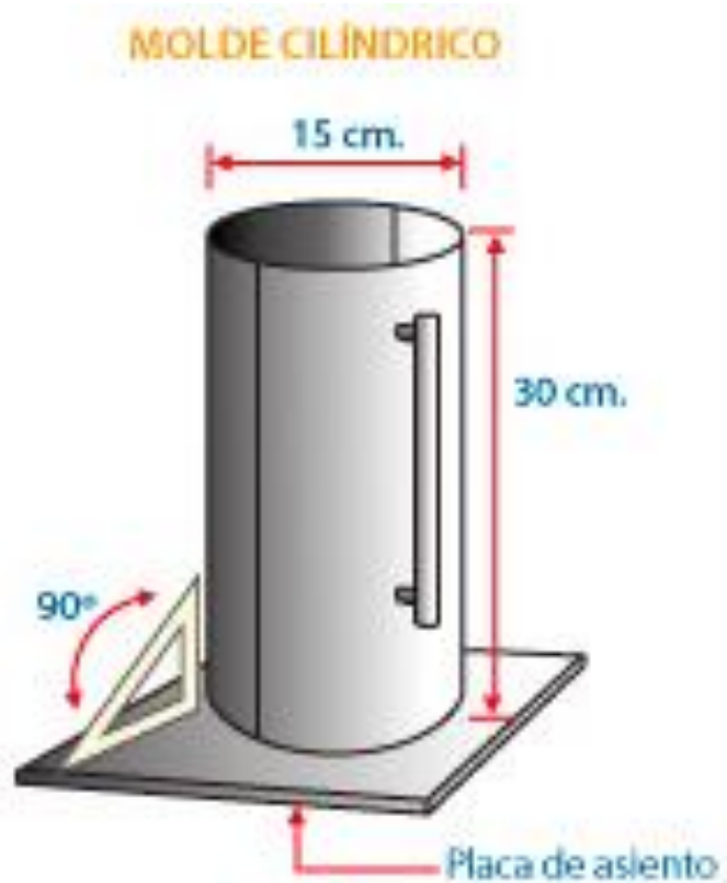
Figura 1: Molde cilíndrico para probetas de concreto
