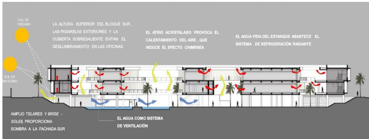
FIGURA 17. Modelo ecológico de un edificio sostenible.
