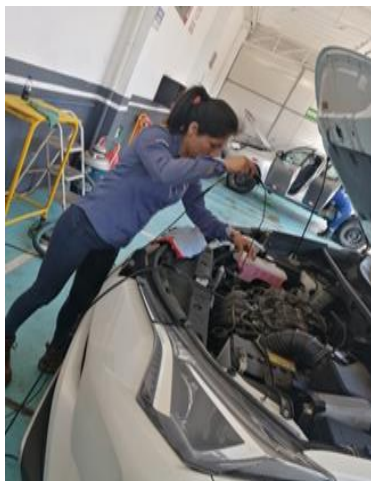
Figura 12. Colocación de la sonda de medición de temperatura y colocación de la sonda de medición de los gases
