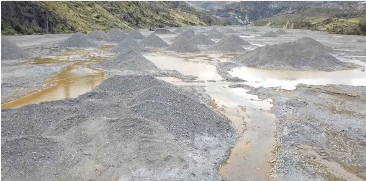
Figura 9: Cantera Chanchairo: Vista del tipo de material, conformado por aluviones, constituida por gravas, arenas y pocos limos, con bloques homogéneos a variables.
