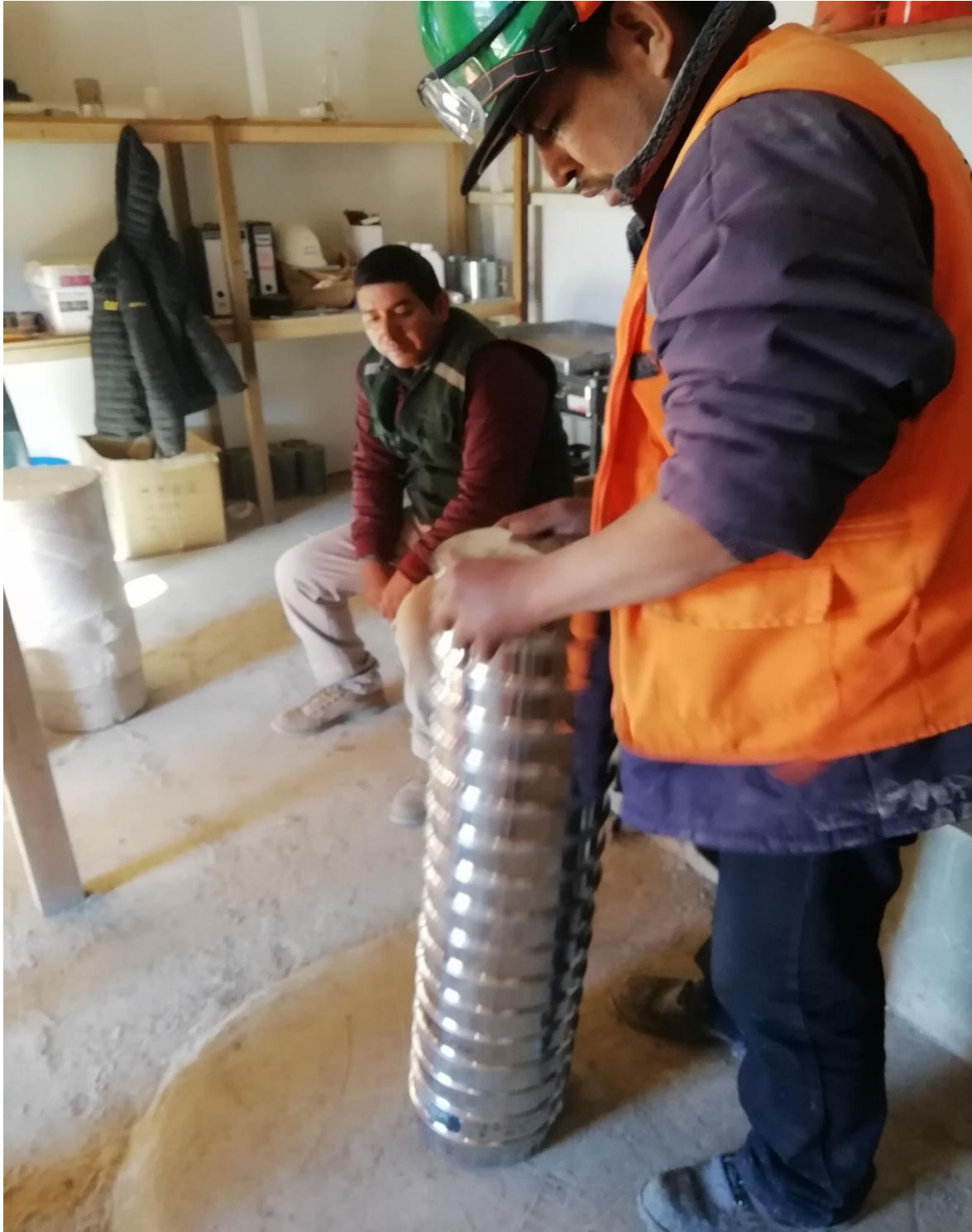
Figura 18. Análisis granulométrico por tamizado de materiales areno gravoso extraído de la cantera chanchairo.
