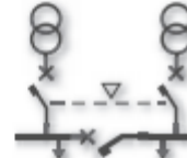
D. Transformador - Transformador/Generador - Acolamiento de barras
