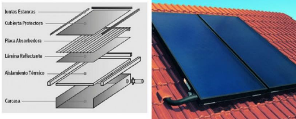
FIGURA 9: Autosor (2017,21 de setiembre) El Captador plano [imagen]. Obtenido de https://autosolar.es/blog/aspectos-tecnicos/que-diferencia-existe-entre-los-paneles-solares-termicos-y-los-paneles-fotovoltaicos
