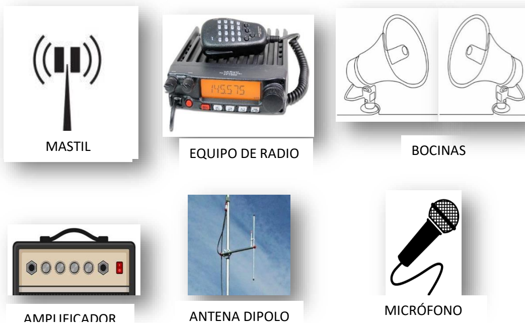
FIGURA N°1: Equipos para la implementación del SAT por radio frecuencia de onda corta.
