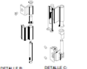
DETALLE B: Bisagra superior reversible reforzada DETALLE C: Bisagra inferior reversible reforzada
