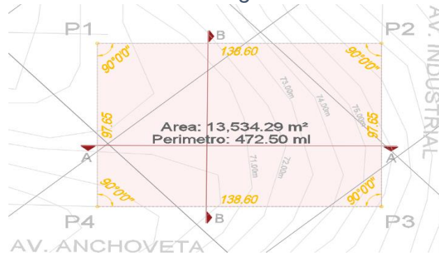
Ilustración 40: Polígono de terreno
