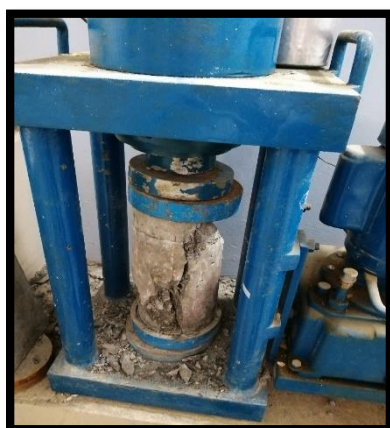
Figura 3: rotura de probetas tiempo de curado 7, 14 y 28 días
