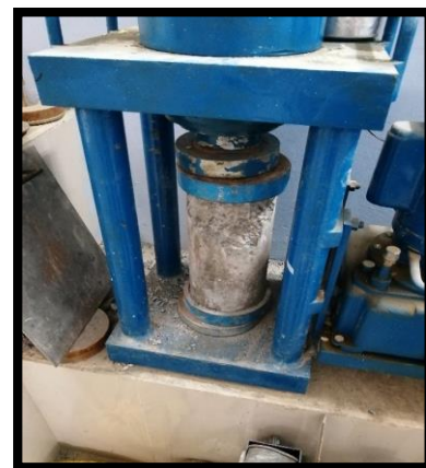
Figura 3: rotura de probetas tiempo de curado 7, 14 y 28 días
