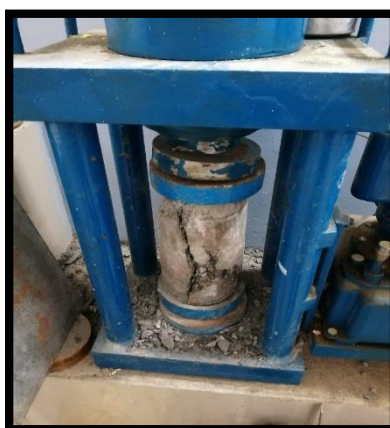
Figura 3: rotura de probetas tiempo de curado 7, 14 y 28 días
