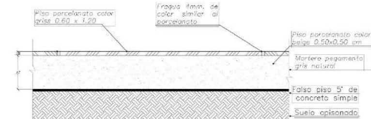
SECCION 04 ESC. 1/25 PISO DE PORCELANATO .60x.120
