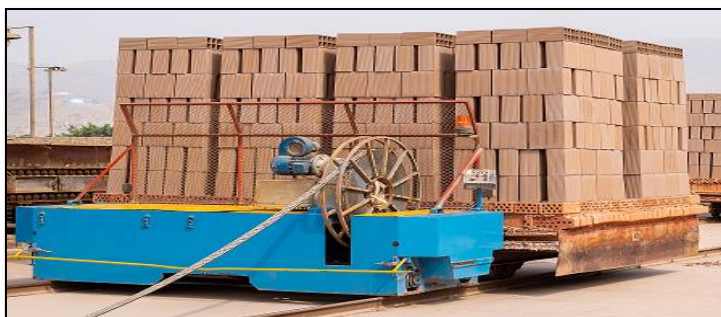
Figura 10 Vagón con ladrillos de hueco 15
