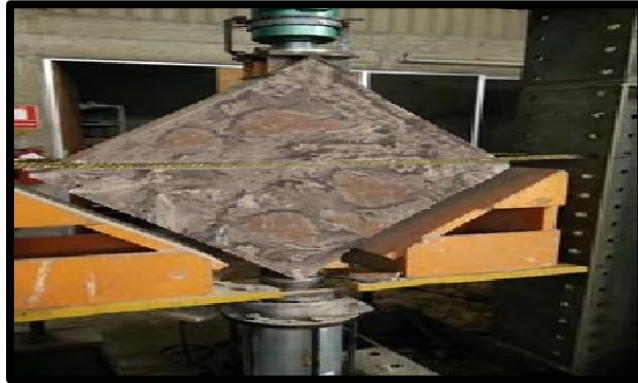
Figura N° 24: Murete de pirca colocada en la maquina sin reforzamiento
