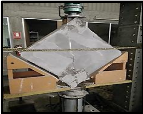
Figura N° 29: Falla por tracción diagonal del murete de pirca reforzada
