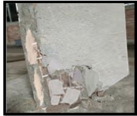
Figura N° 29: Falla por tracción diagonal del murete de pirca reforzada
