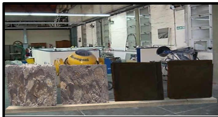
Figura N° 23: Muretes de pircas naturalmente y con tarrajeo
