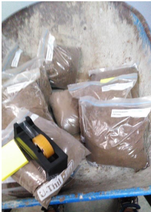
Figura 6.12: Muestras extraídas (4 calicatas) de la carretera Trujillo – Laredo.
