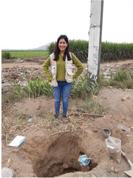
Figura 6.11: Extracción de muestra de Calicata 4 de carretera Trujillo – Laredo.
