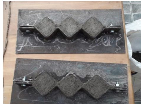
ELABORACION DE TESTIGOS CUBICOS MORTERO PATRON
