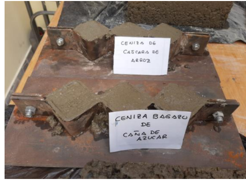
DOSIFICACION Y ELABORACION DE TESTIGOS CUBICOS MORTERO PATRON
