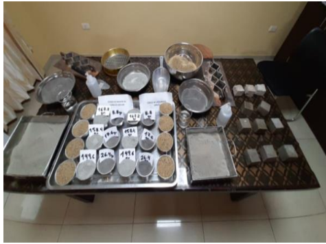
DOSIFICACION Y ELABORACION DE TESTIGOS CUBICOS MORTERO PATRON
