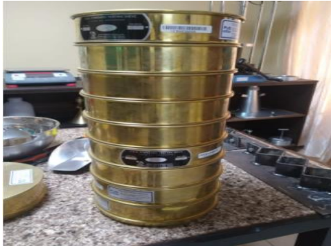
Caracterización de agregado
