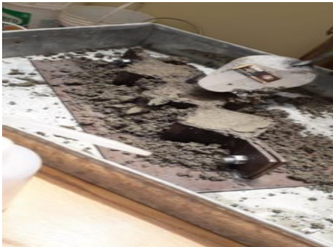
ELABORACION DE TESTIGOS CUBICOS MORTERO PATRON
