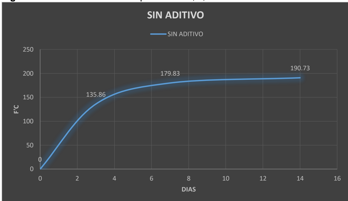
Figura 01.- Resistencia a la compresión en 3, 7, 14 días sin aditivo.
