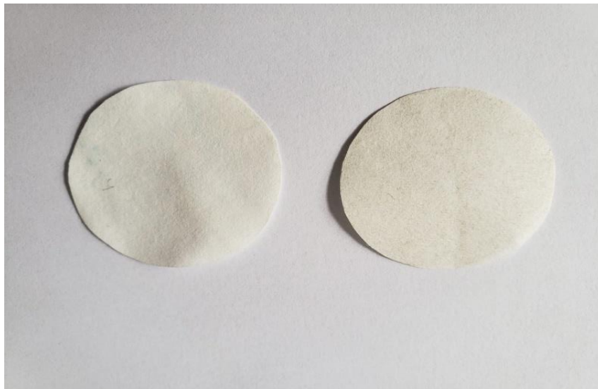
Imagen 12. Antes y después del monitoreo de los filtros
