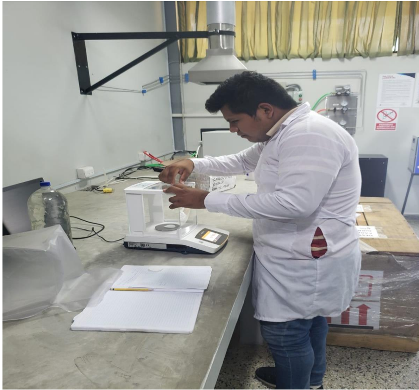
Imagen 9. Pesado de filtro en balanza analítica antes de realizar el monitoreo
