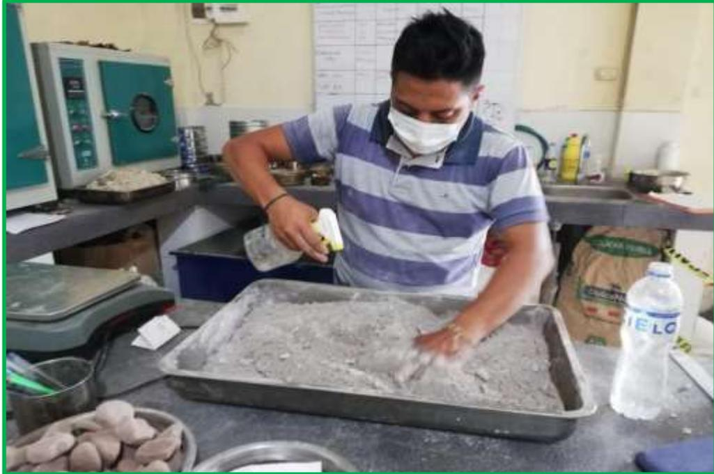
**FOTOGRAFÍA 24:** Incorporación del agua al material romerillo.
