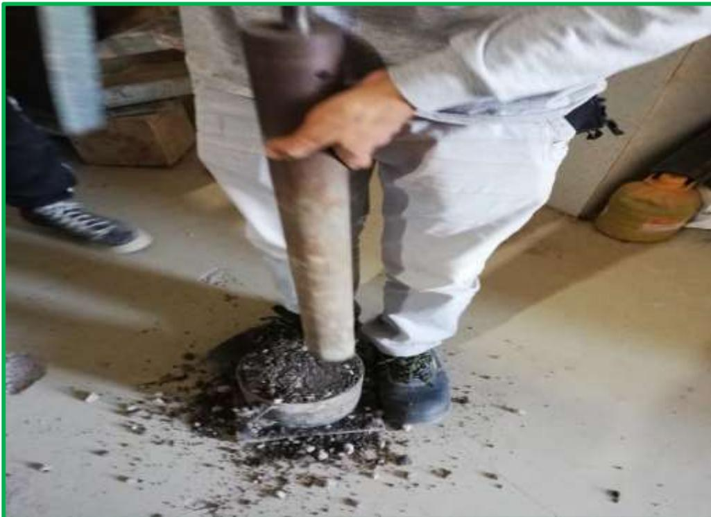
**FOTOGRAFÍA 44:** Perfilando en material compactado con el martillo.
