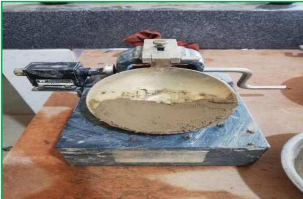
**FOTOGRAFÍA N° 18:** Determinación límite líquido utilizando la copa de Casagrande.
