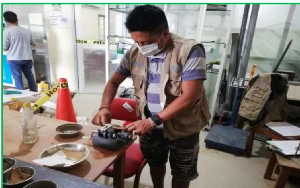
**FOTOGRAFÍA N°19:** Realizando el límite plástico del suelo natural para su clasificación.
