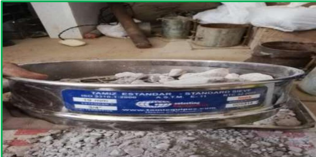
**FOTOGRAFÍA 22:** Material romerillo tamizado, pesado, listo para la mezcla con agua y ver su contenido de humedad en el ensayo de proctor modificado.
