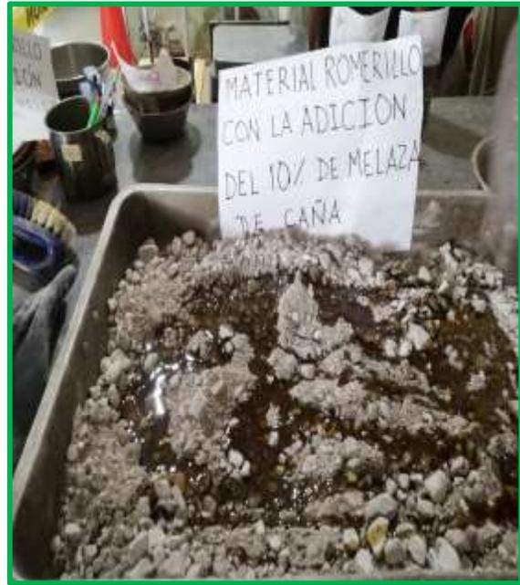
**FOTOGRAFÍA 43:** Compactación Material romerillo con la adición de melaza de caña.
