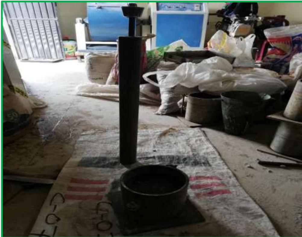
**FOTOGRAFÍA 27:** Molde para el ensayo del proctor modificado
