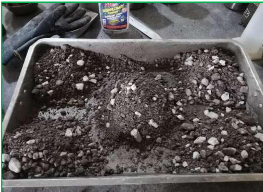
**FOTOGRAFÍA 40:** Molde ya compactado con la adición de melaza de caña.
