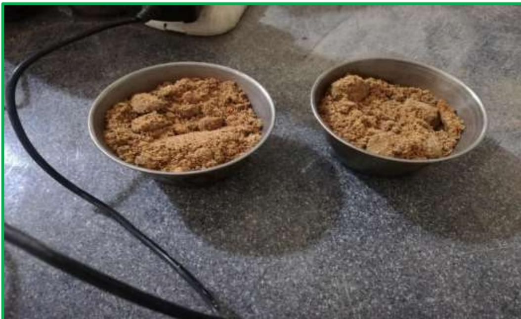
**FOTOGRAFÍA 07:** Clasificación de suelos (secado de las muestras en el horno)
