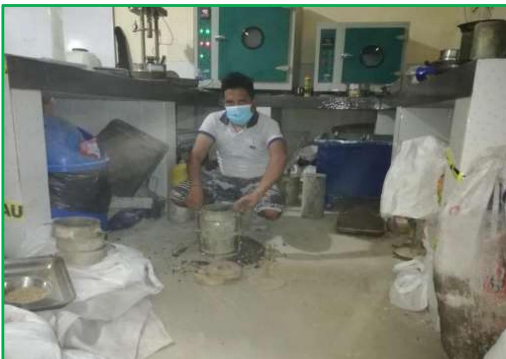
**Fotografía 47:** Acondicionando los moldes, con las pesas para luego calibrar el dial para luego sumergirlas en el tanque de agua.
