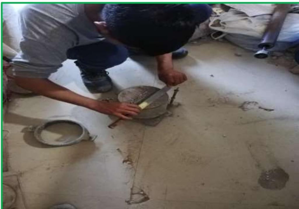
**Fotografía 45:** Molde con el material compactado
