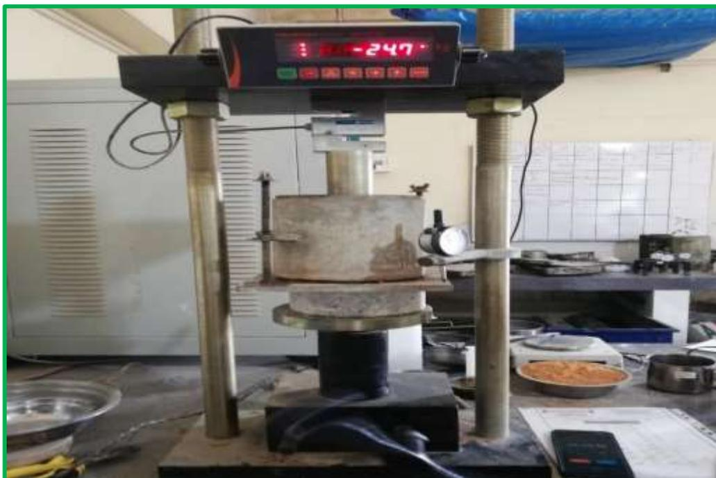
**Fotografía 52:** Realizando la penetración de los moldes en la prensa, en el ensayo de CBR.
