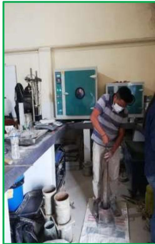
**FOTOGRAFÍA 30:** Molde con material ya compactado con el martillo.
