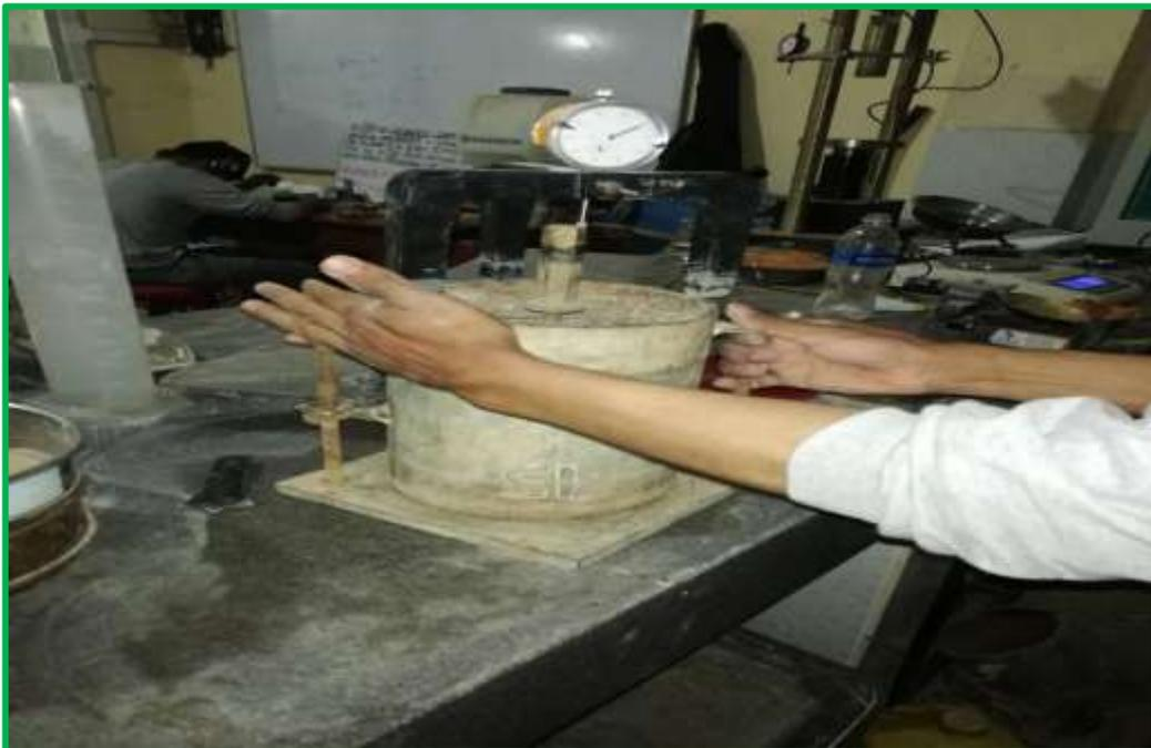
**Fotografía 49:** Moldes sumergirlos en el tanque de agua en este paso se toma la verificación del dial cada 24 horas durante 4 días para luego realizar la penetración en la prensa CBR.
