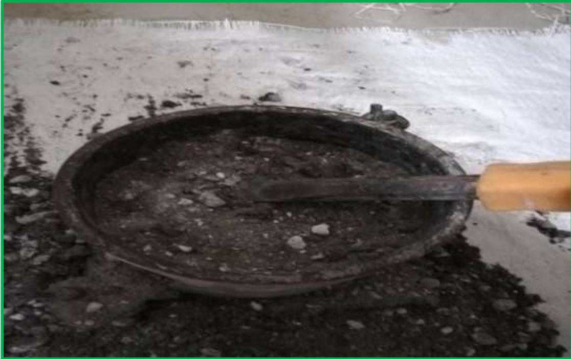
**FOTOGRAFÍA 41 – 42:** Material de romerillo con la adición de 10% de melaza de caña.
