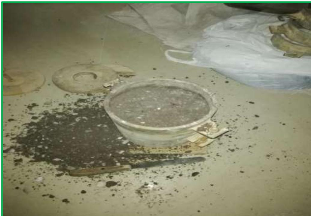
**Fotografía 46:** Acondicionando los moldes, con las pesas para luego calibrar el dial y luego sumergirlas en el tanque de agua.
