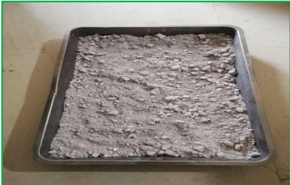
**FOTOGRAFÍA 25:** Separación de la muestra en 5 partes para realizar los golpes en el molde por capas en el proctor modificado.
