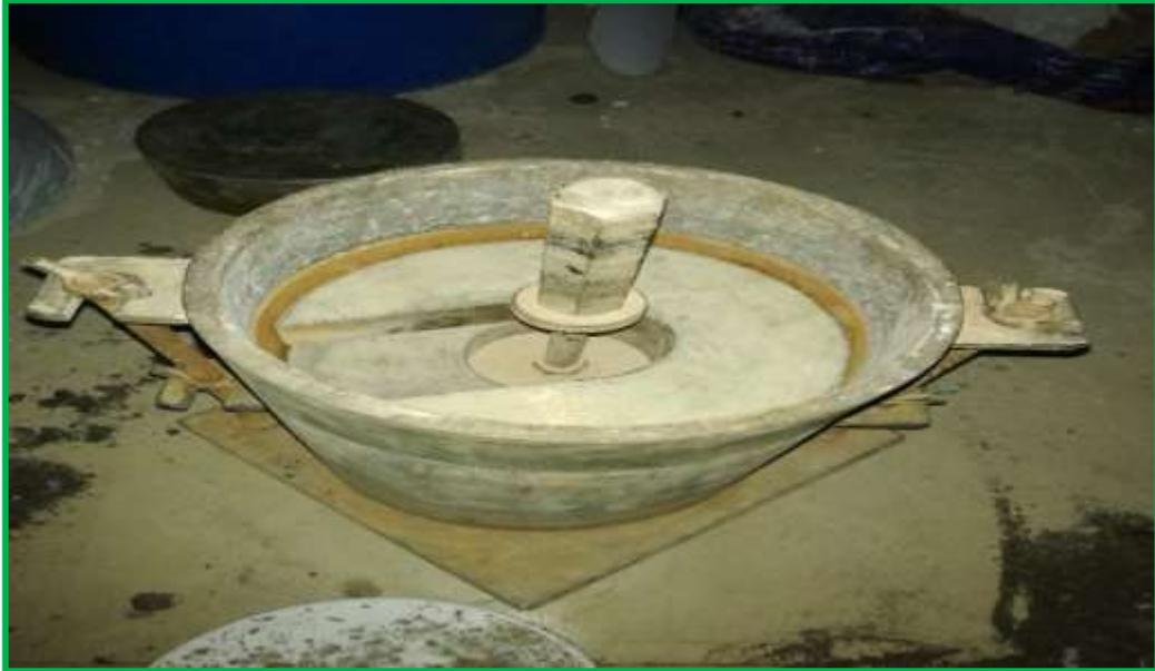
**Fotografía 48:** Instalación y calibración del dial en el molde.
