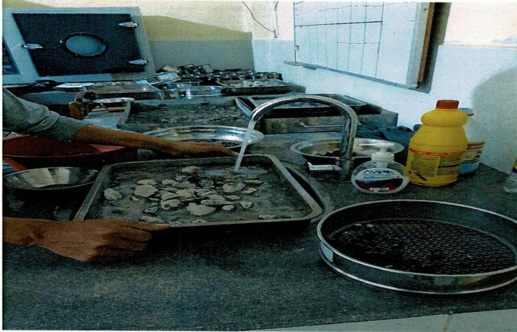
Fotografía N° 15. Secado de material sacado después de horno, para determinar el estado superficial saturado superficialmente seco.
