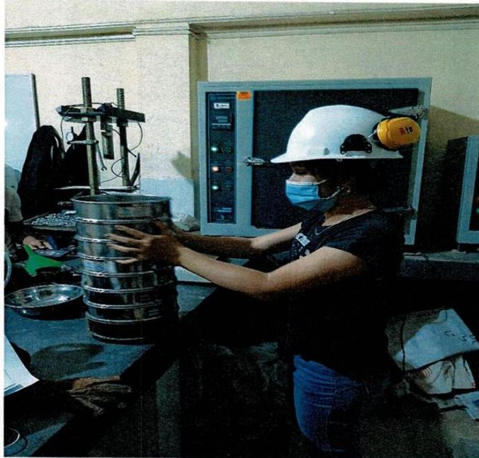
Fotografía N° 08. Tarado del agregado retenido en las diferentes mallas.
