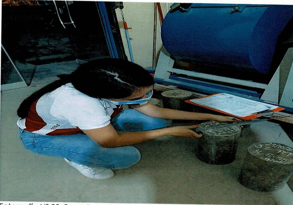
Fotografía N° 02. Peso de probetas.
